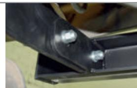
**ШАГ 7.** Затяните все резьбовые соединения. Установите глушитель на свои посадочные места. Установка завершена.
