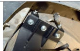
**ШАГ 5.** Установите балку ТСУ между боковых, совместив отверстия балки ТСУ и боковых кронштейнов, и соединив всё с помощью болтов М12х1,25х40 через шайбы 12 с двух сторон и шайбы 12 гроверные, гайками М12х1,25
