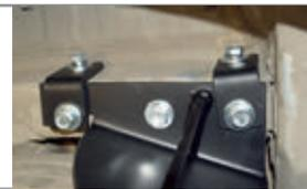
**ШАГ 4.** Установка правого кронштейна производится аналогично установке левого кронштейна, соединения не затягивайте.
