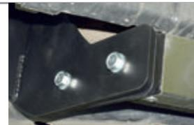
**ШАГ 6.** Отрегулируйте положение фаркопа, обеспечив небольшой зазор между центральным кронштейном и бампером автомобиля.
