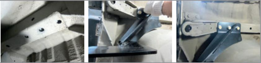
**ШАГ 3.** Установите кронштейн левый, совместив отверстия кронштейна с отверстиями в лонжероне автомобиля и соедините их с закладными пластинами с помощью болтов M12x1,25x40 через шайбы 12 и шайбы 12 гроверные.
