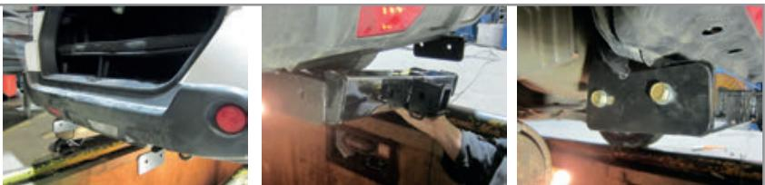
**ШАГ 5.** Затяните все соединения, отрегулировав положение ТСУ. Установите съёмный шар в сборе и закрепите его пальцем гнутым гальванизированным со шплинтом пружинным игольчатым. Затяните шар ключом на 38 мм.
