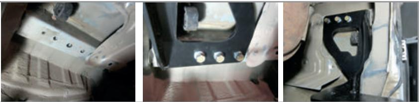
**ШАГ 4.** Установите задний бампер с усилителем согласно руководства по ремонту автомобиля. Установите балку ТСУ, совместив отверстия в боковых кронштейнах с отв-ми балки, и соедините их с помощью болтов M12x1,25x40 через шайбы и гроверы 12.
