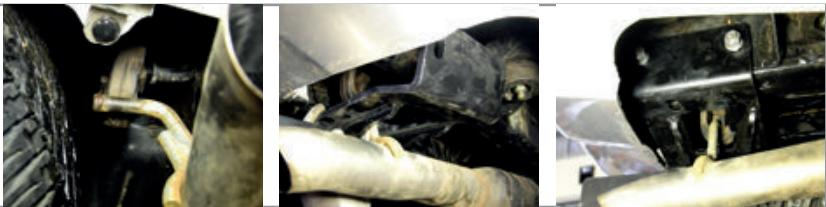
**ШАГ 3.** Установите закладную пластину в нишу правого лонжерона продев шпильку пластины в отверстия лонжерона и кронштейна как показано на фото. Закрепите кронштейн с помощью гайки M12 через гроверную шайбу 12 и шайбу 12. Повторите на левой стороне.
