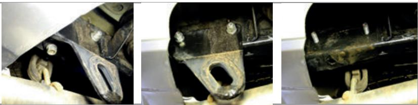
**ШАГ 2.** Освободите глушитель с посадочного места для удобства установки кронштейна. Установите кронштейн, совместив отверстия кронштейна со штатными шпильками в лонжероне. Соедините всё с помощью штатных гаек и шайб.
