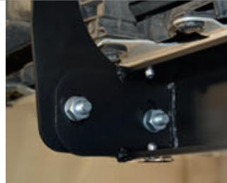
**ШАГ 6.** Установите фиксирующий болт M10x20 с шайбой 10 снизу, он используется для исключения технологических люфтов съемного шара и только в ненагруженном состоянии! Перед сцепкой болт демонтировать! Установка завершена!
