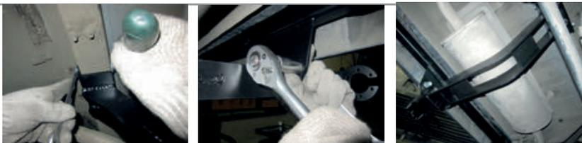
**ШАГ 5.** Установите кронштейн крепления электрической розетки (поз. Q). Установите съемный шар в сборе и закрепите его пальцем гнутым с шплинтом. Затяните шар ключом на 38 мм.
