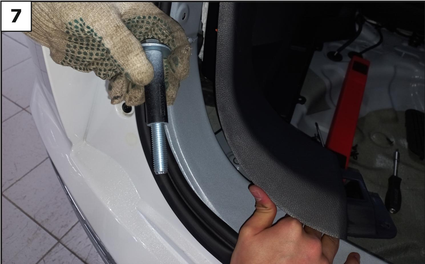
Установить в рассверленные отверстия болты М12х100 (9) с шайбами 12 увел. (13) и втулками (15).
