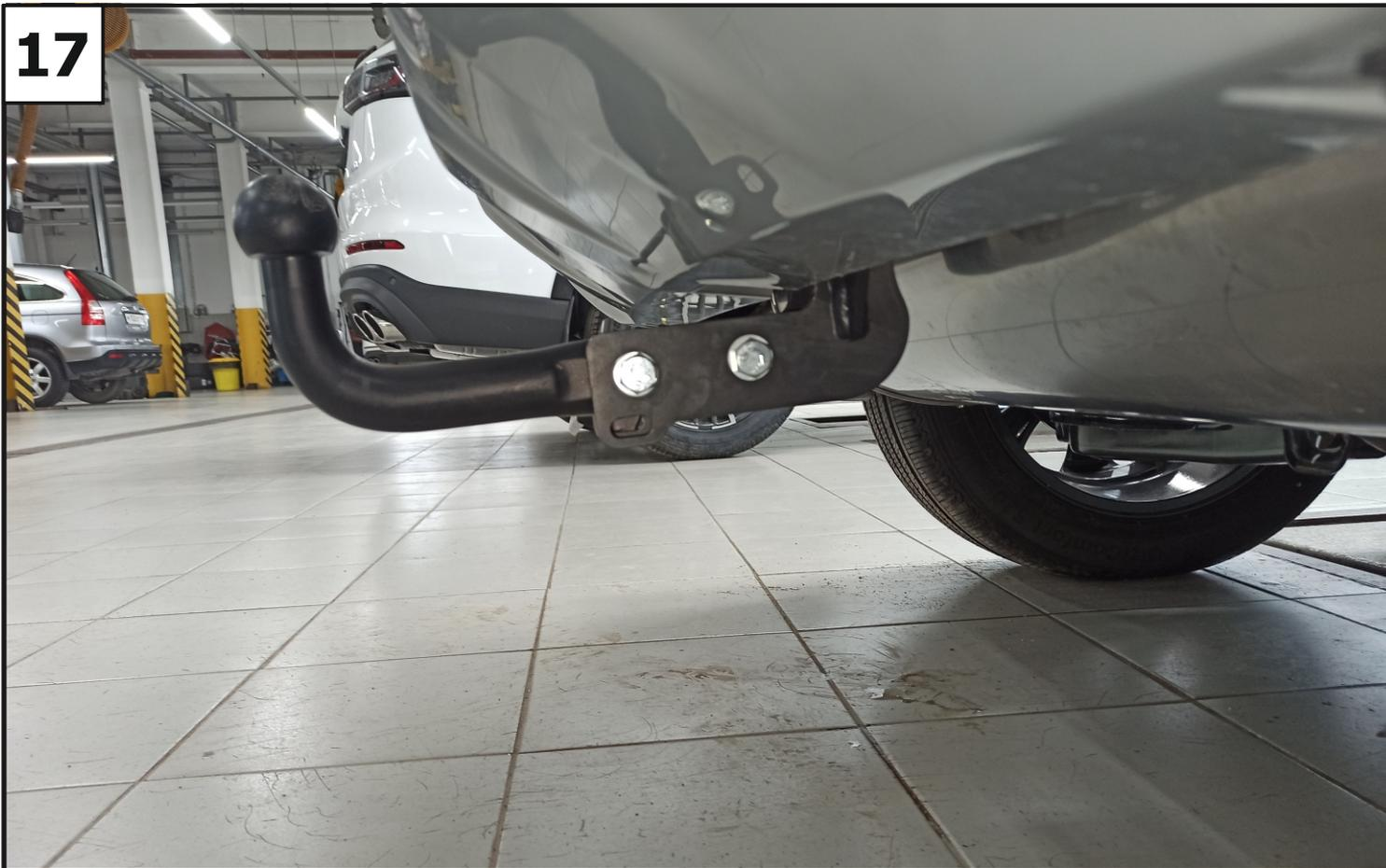
**Затянуть все резьбовые соединения. Моменты затяжки: M12=81Нм**
