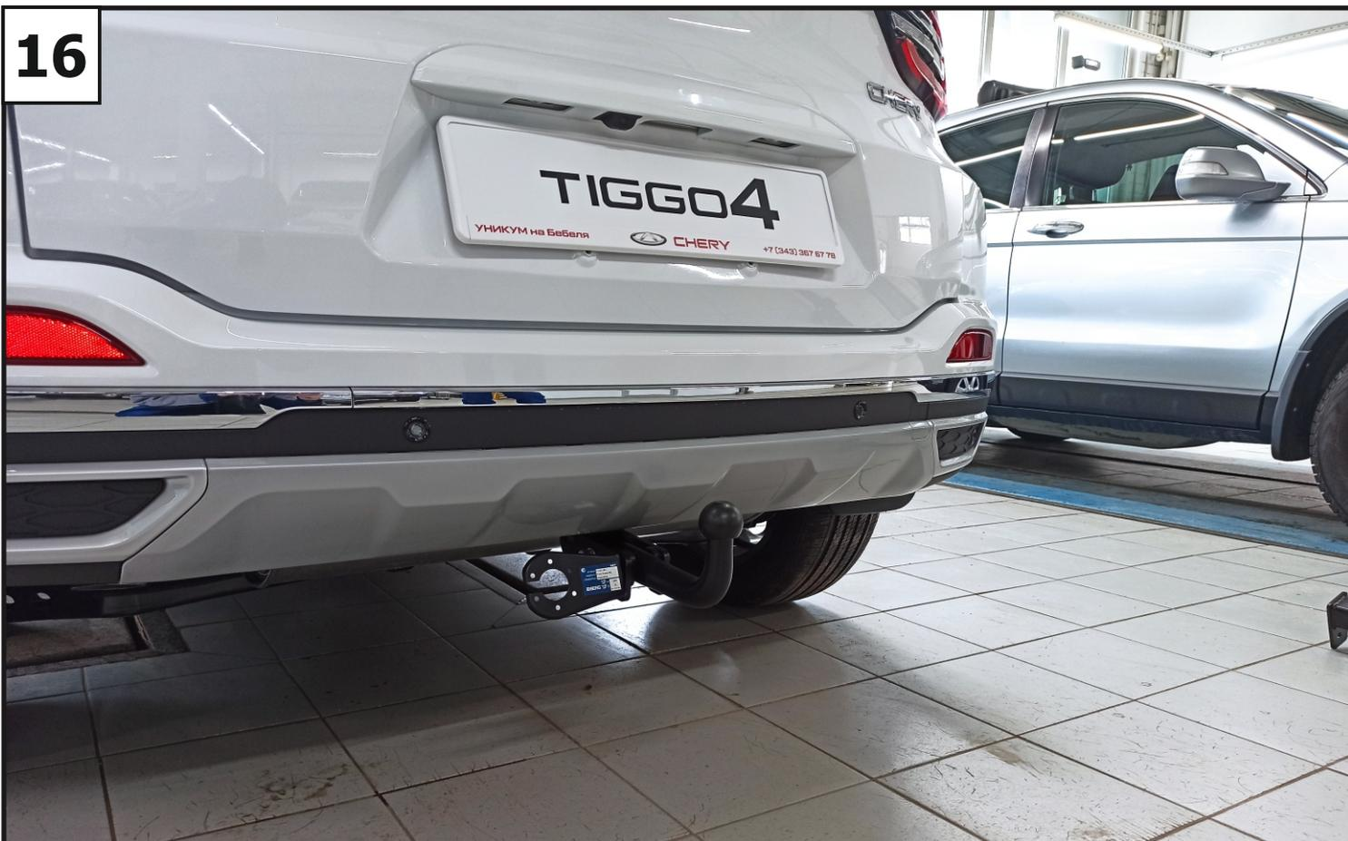
**Установить кронштейн под розетку (4) и крюк (5) с помощью болтов M12x1,25x90 (8), шайб 12 (12), шайб 12 пружинных (14) и гаек 12x1,25 (10).**
