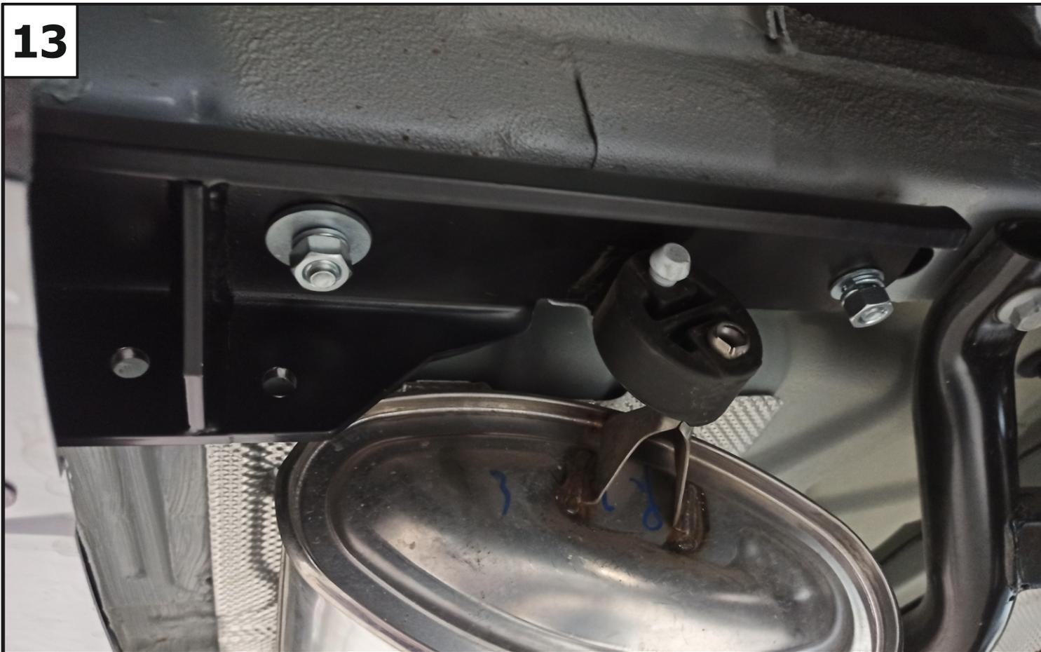
Закрепить правый и левый кронштейн (2), (3) с помощью гаек 12x1,25 (10), шайб 12 (12) и шайб 12 пружинные (13).
