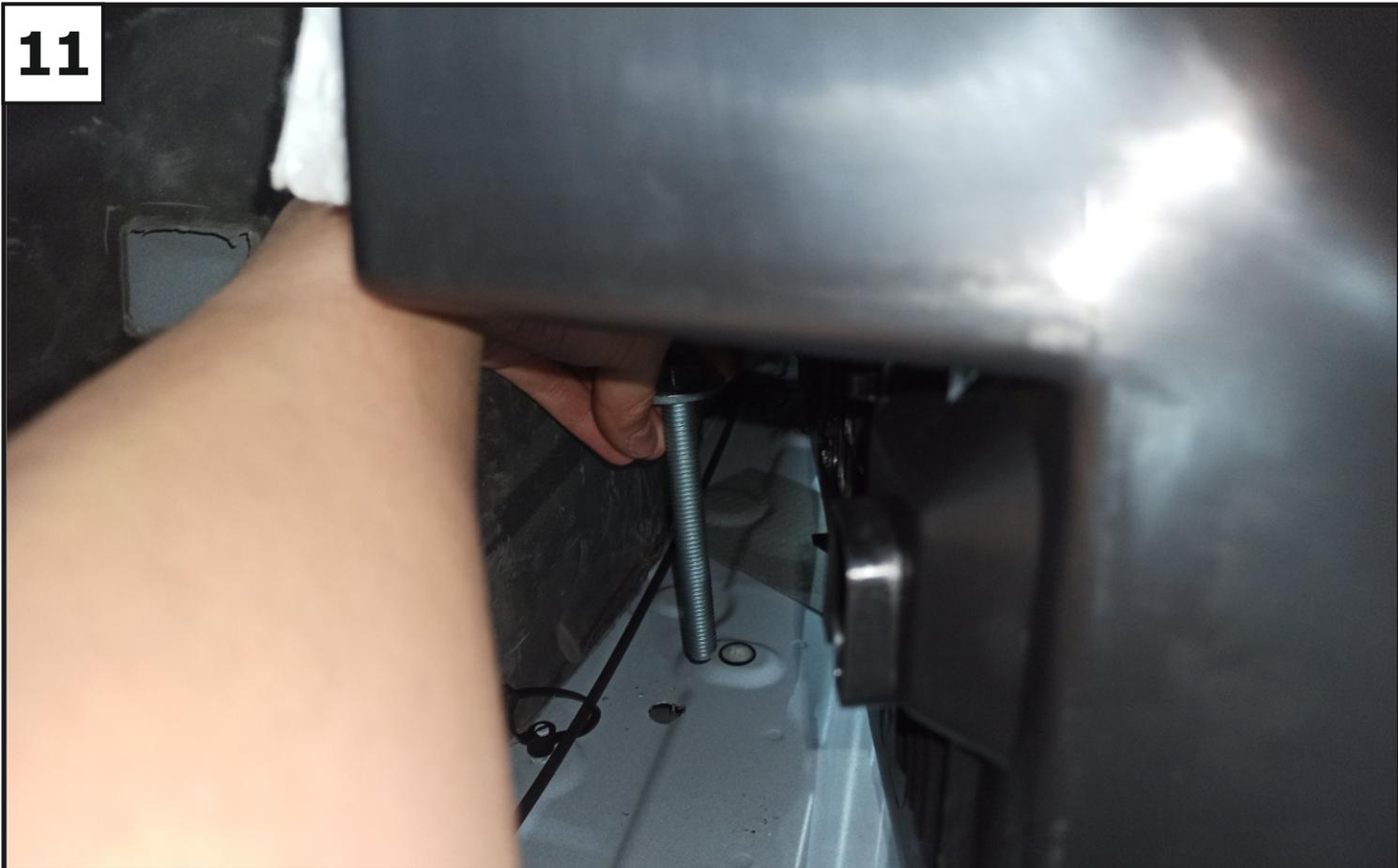
Установить болты 12x100 (9) и шайбы 12 увел. (14) в дальние отверстия с двух сторон.
