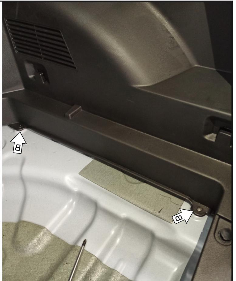
Выкрутить винты В обшивки багажника.
