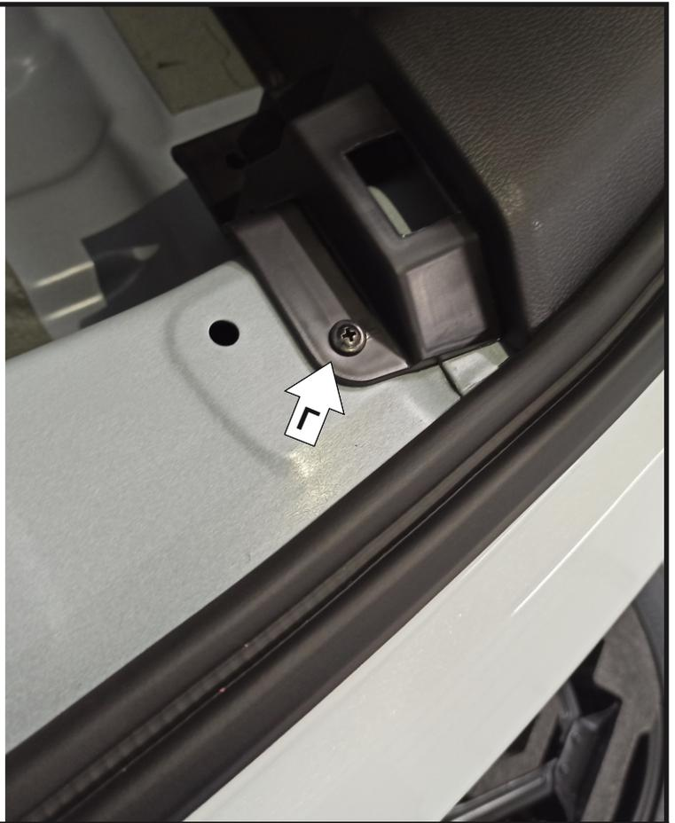
Выкрутить винты Г багажника и отогнуть обшивку с двух сторон.
