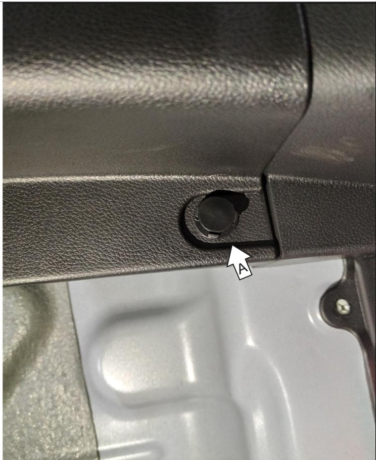
**Демонтировать клипсы А обшивки багажника.**
