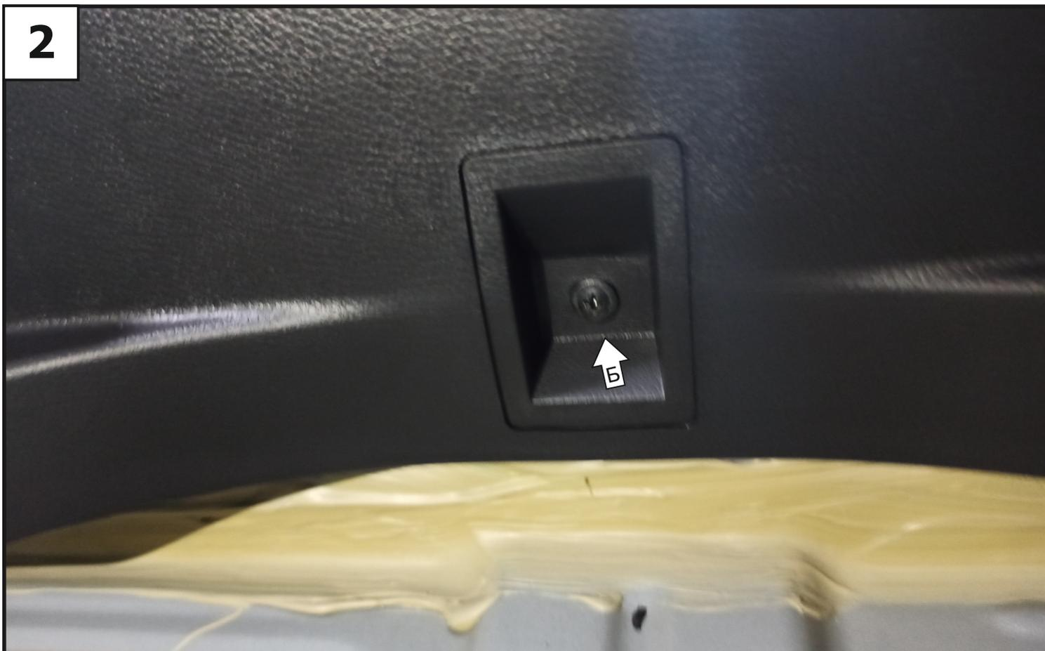
**В центре накладки выкрутить винт Б обшивки багажника.**
