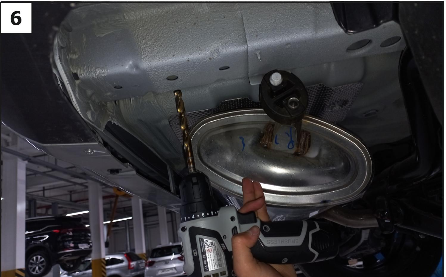
Через отверстие в лонжерон просверлить пол багажника сверлом диаметром 12,5 мм. Со стороны багажника рассверлить это отверстие до диаметра 20 мм. С другой стороны аналогично.
