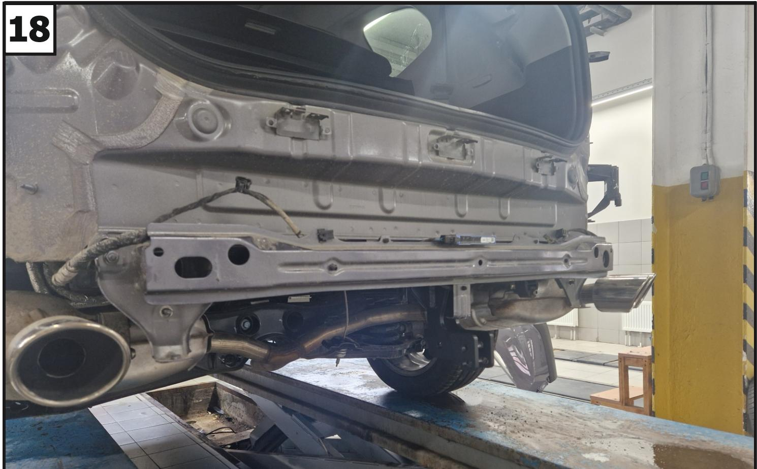
Затянуть все резьбовые соединения, сначала затянуть балку с кронштейнами, затем кронштейны с лонжеронами и закладными. Моменты затяжки: M8=25 Нм, M10=47 Нм, M12=81 Нм. Установить подвесы глушителя и усилитель в обратной последовательности.
