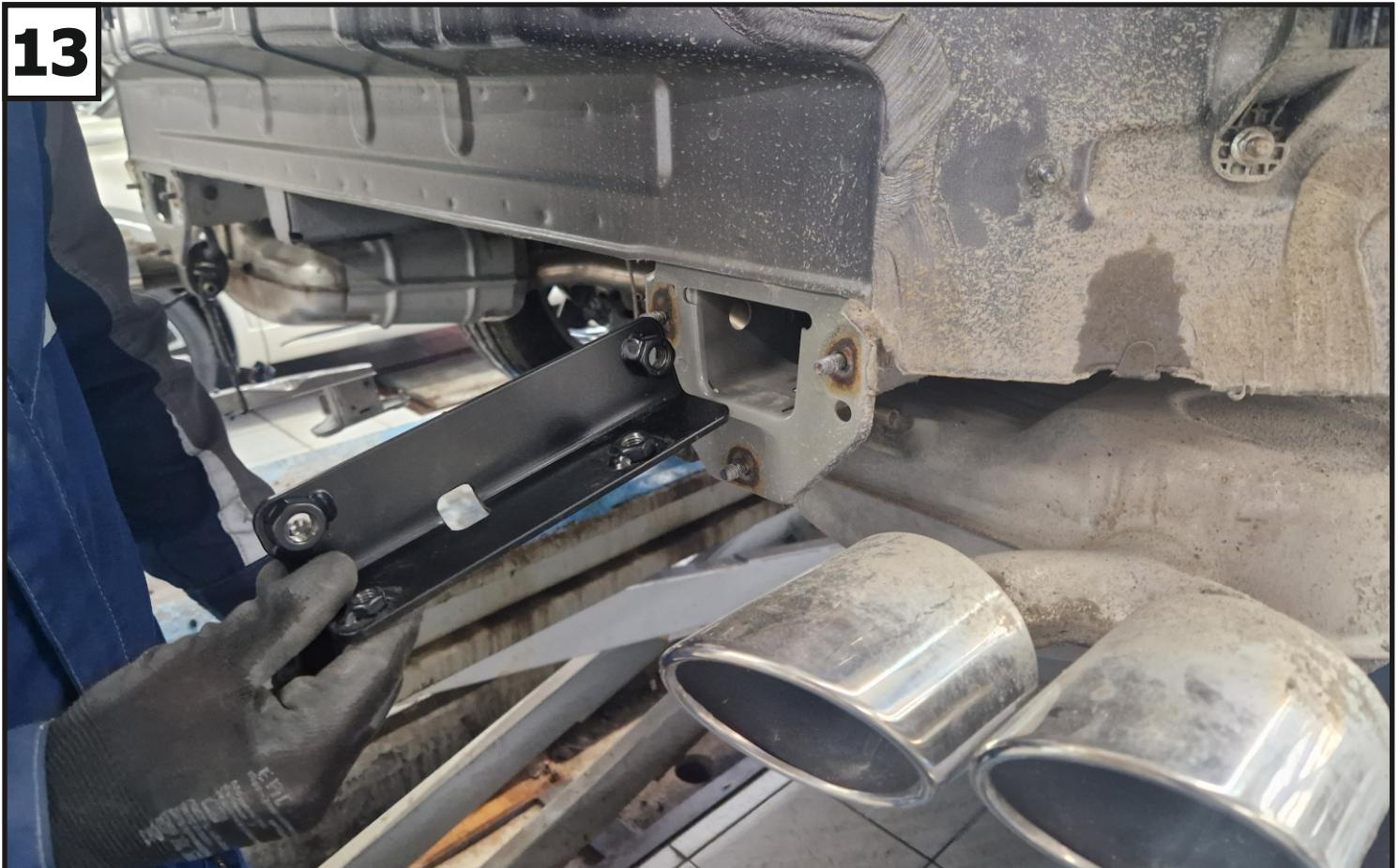
Установить в лонжероны автомобиля закладные (4) и (5), согласно их стороне. При наличии в лонжеронах штатных гаек - закладные не используются.
