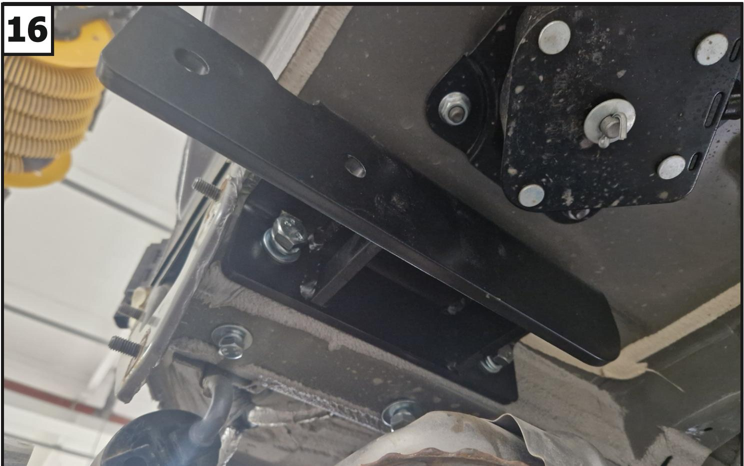
Установить кронштейны (2) и (3) согласно их стороне, закрепив их с помощью болтов M12x1,25x40 (15), шайб 12 пружинных (23) и шайб 12 (24).
