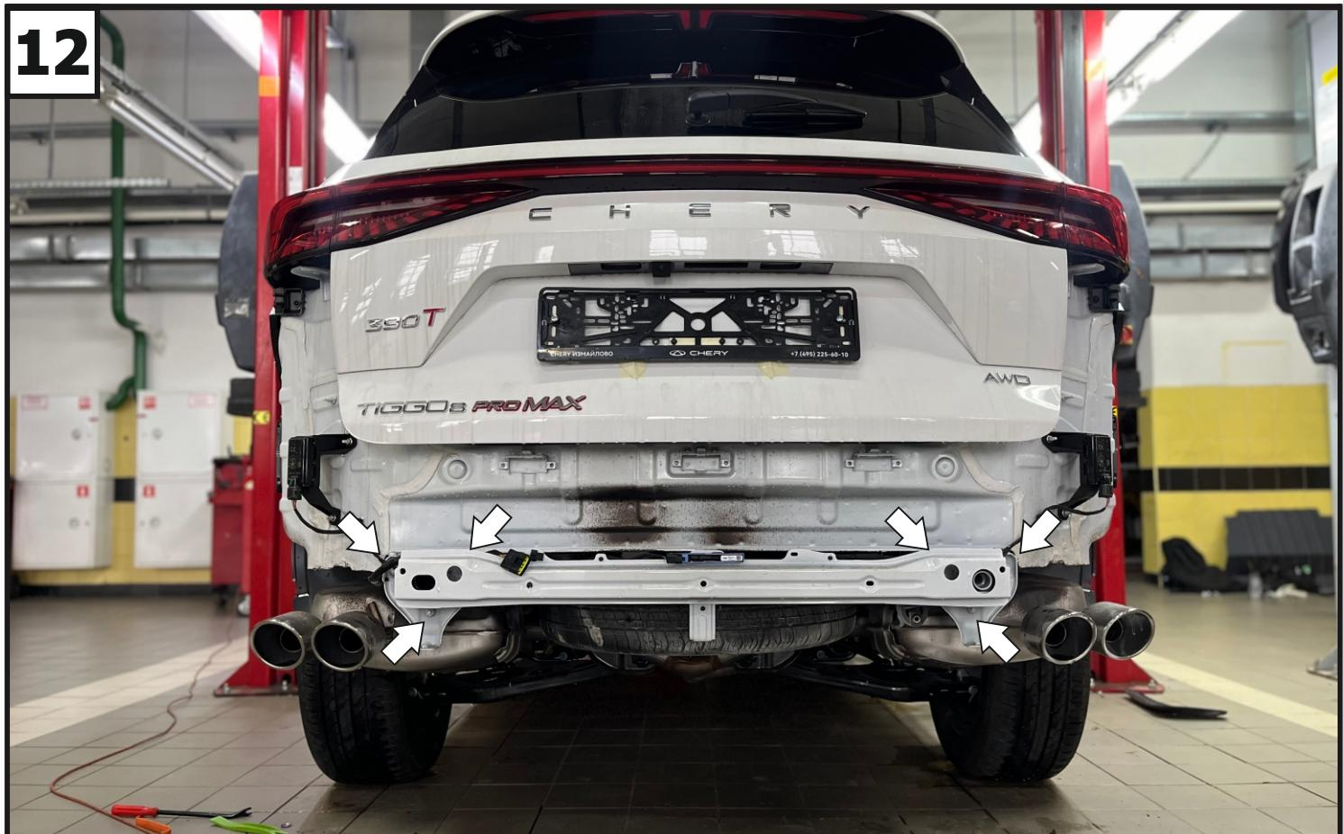
Отсоединить фишки боковых радаров, отсоединить точки крепления проводки и антенну бесключевого доступа от заднего усилителя. Открутить гайки крепления усилителя и демонтировать его.
