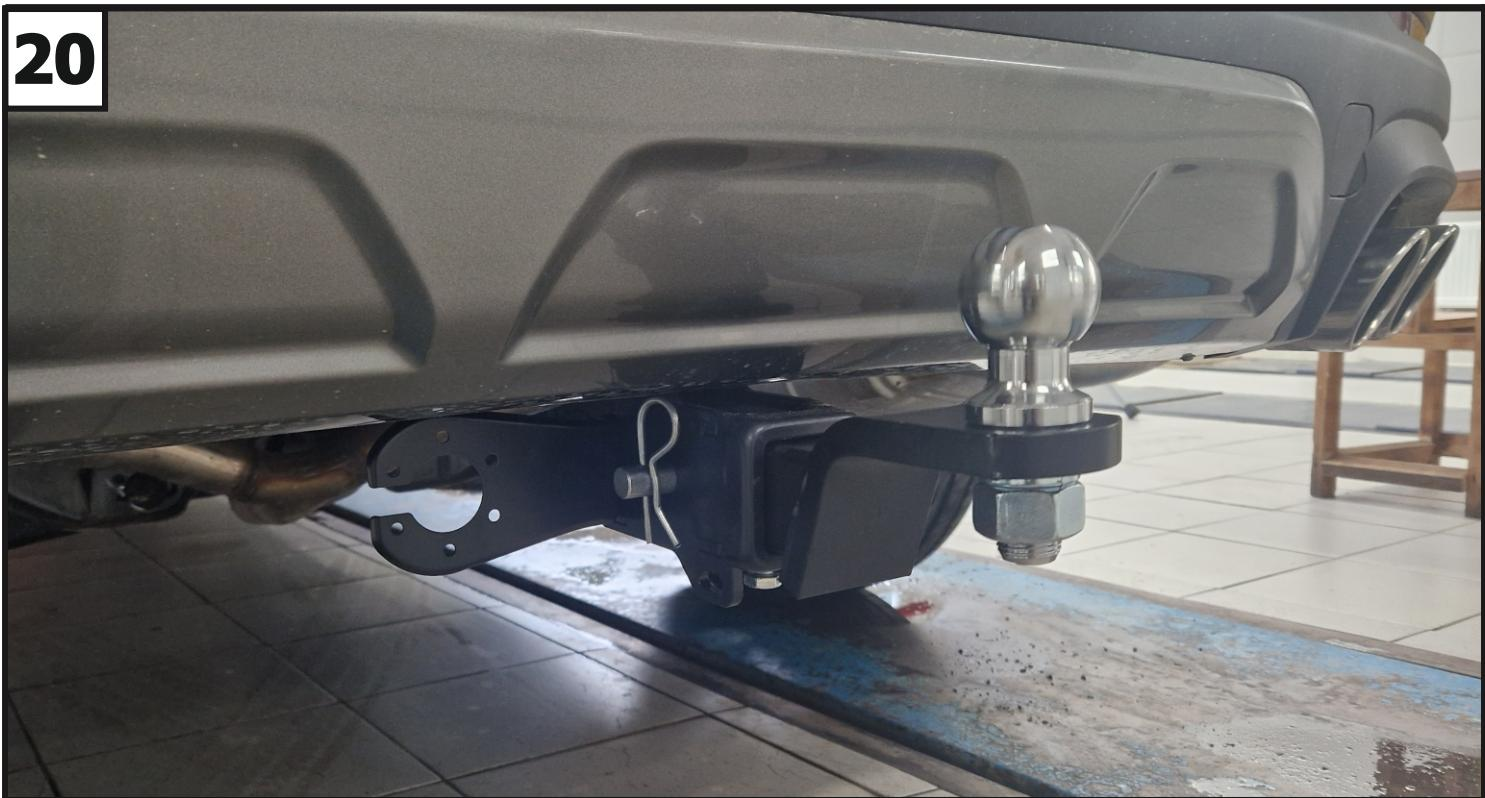
Установить кронштейн под розетку (10) на балку (1) с помощью болта M8x80 (12), шайбы 8 (19), шайбы 8 пружинной (18), шайбы 8 увел. (20) и гайки 8 (16). Установить переходник (6), закрепив с помощью штифта (8) и шплинта (9). Зафиксировать переходник болтом M10x20 (13) - фиксацию использовать только без нагрузки. Установить на переходник шар (7), закрепив гайкой M24 (24) с шайбой 24 пружинной (26). Затянуть все резьбовые соединения. Моменты затяжки: M8=25 Нм.
