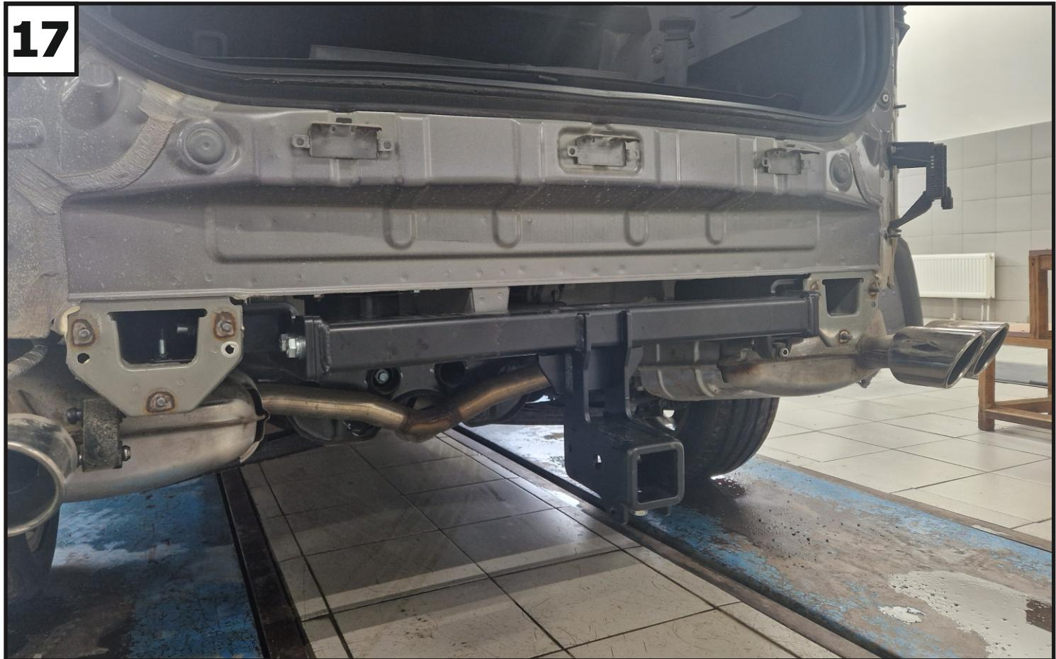
Прогнать резьбовые отверстия балки (1) с помощью метчика M12x1,25. Установить балку (1), закрепив её к кронштейнам с помощью болтов M12x1,25x40 (15), шайб 12 пружинных (23), шайб 12 (24) и гаек M12x1,25 (17).
