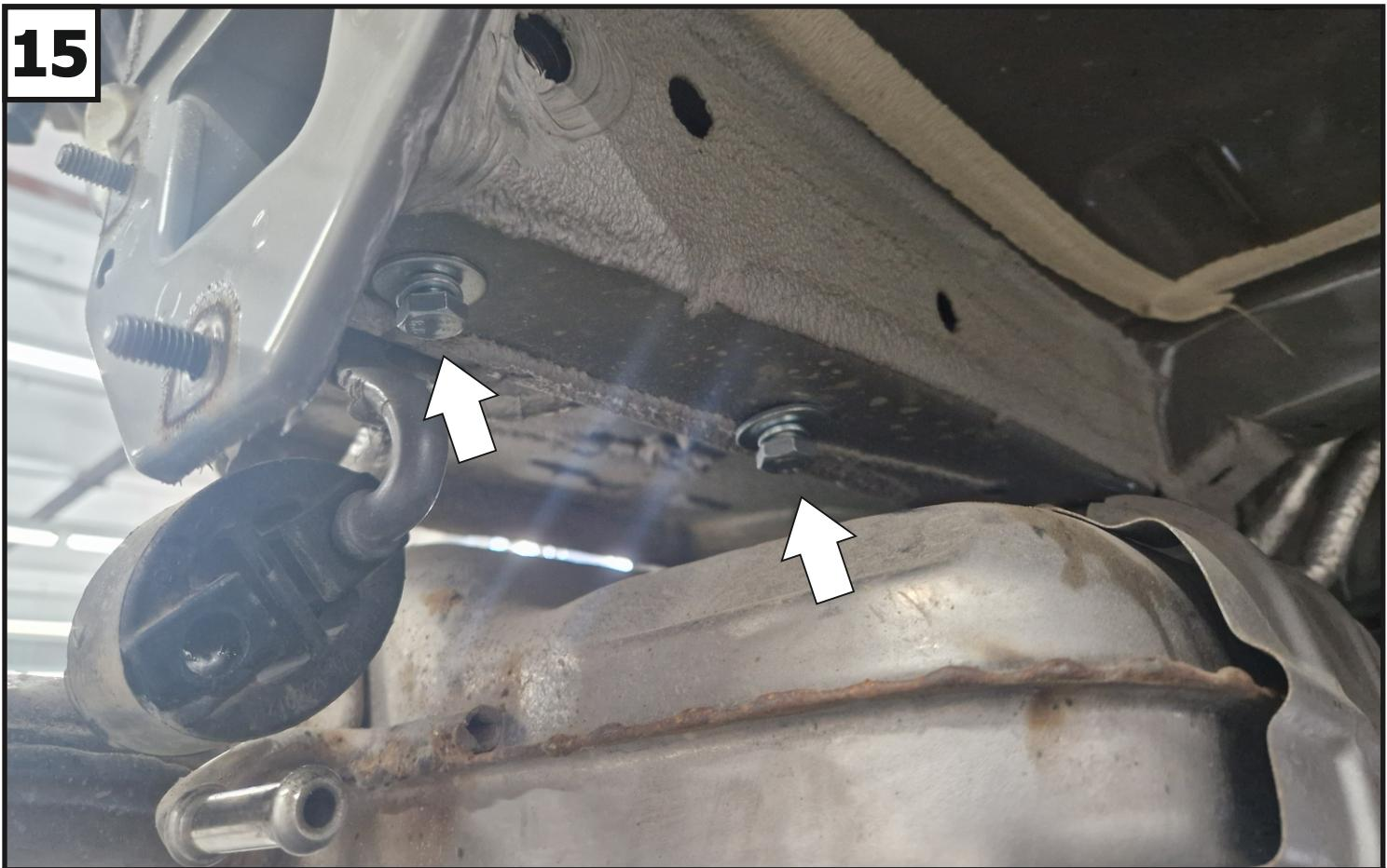
Установленные закладные (4) и (5) закрепить с помощью болтов M8x30 (11), шайб 8 пружинных (18), шайб 8 увел. (20) и болтов M10x1,25x30 (14), шайб 10 пружинных (21) и шайб 10 увел. (22). С другой стороны аналогично.
