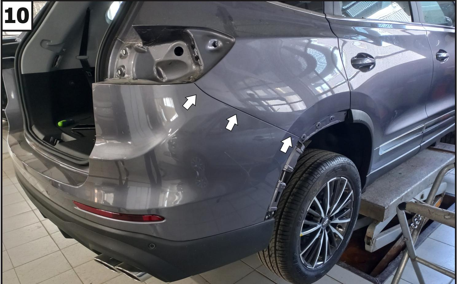
Отщелкнуть боковые защелки бампера с левой и правой стороны. Затем снять задний бампер с автомобиля.
