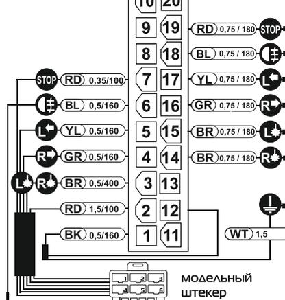
Для вывода сигнала заднего хода на фонарь прицепа, необходимо установить клемму (в комплекте) на синий провод и установить его в гнездо №1 (со стороны установленных в колодку проводов, счёт гнезд слева на право, сверху вниз) белого, модельного брп разъёма на шлейфе проводов.
