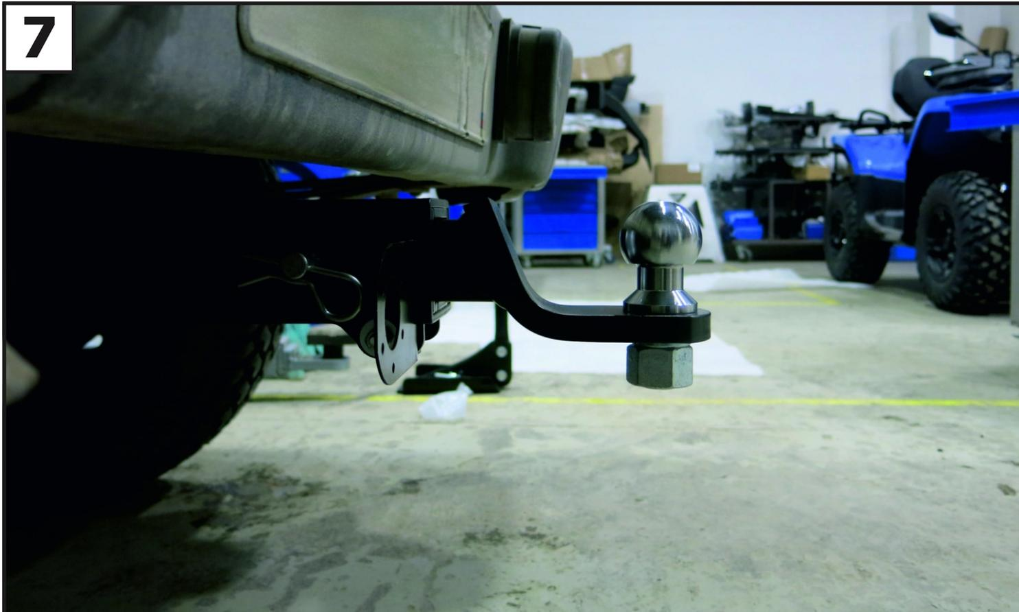
Установить переходник (3), закрепив с помощью штифта (5) и шплинта (6). Зафиксировать переходник болтом М10х20 (9) - фиксацию использовать только без нагрузки. Установить на переходник шар (4), закрепив гайкой М24 (18) с шайбой 24 пружинной (19).
