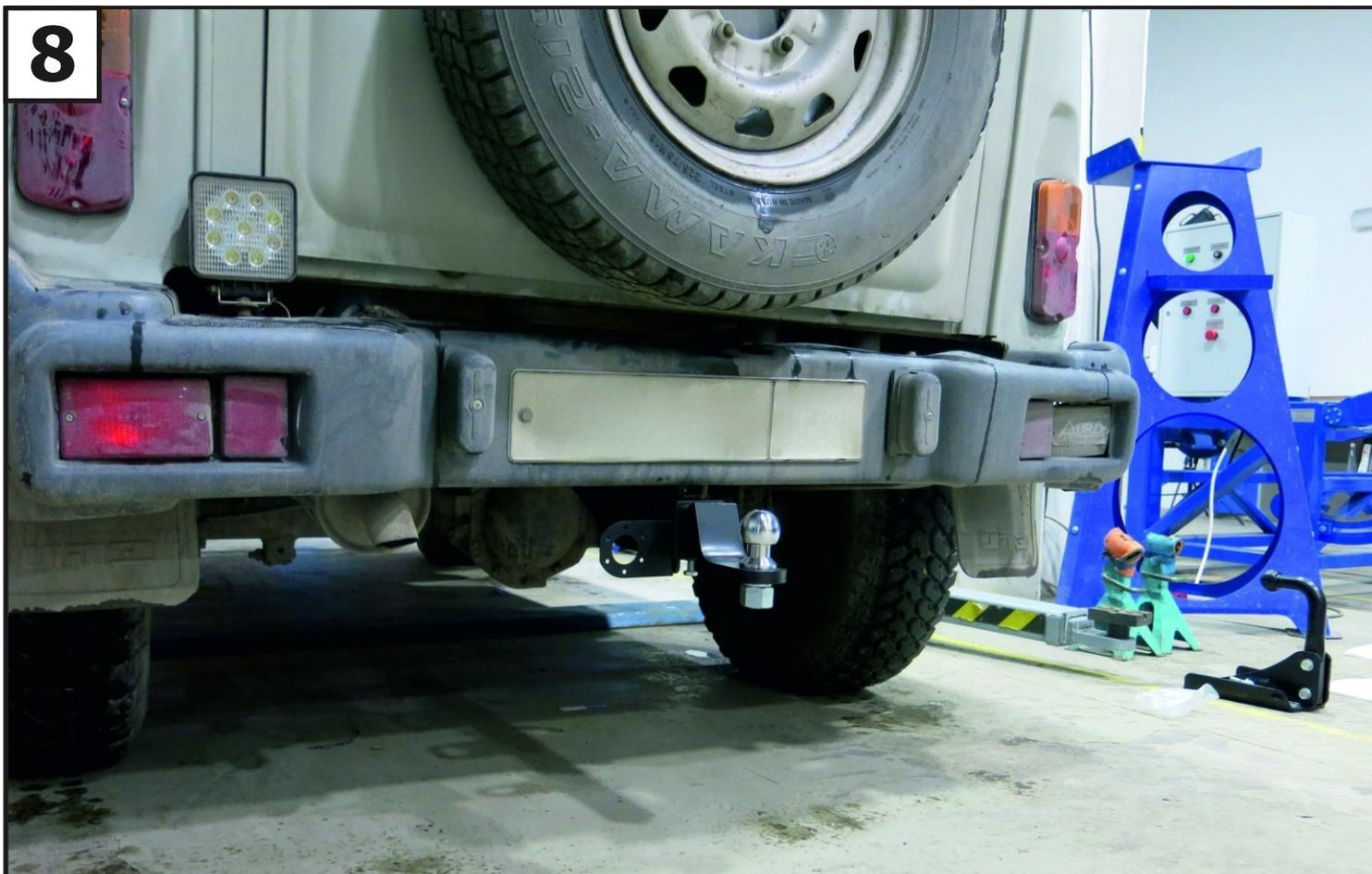
Затянуть все резьбовые соединения. Моменты затяжки: М8=25 Нм, М10=47 Нм, М12=81 Нм, М24=95 Нм.
