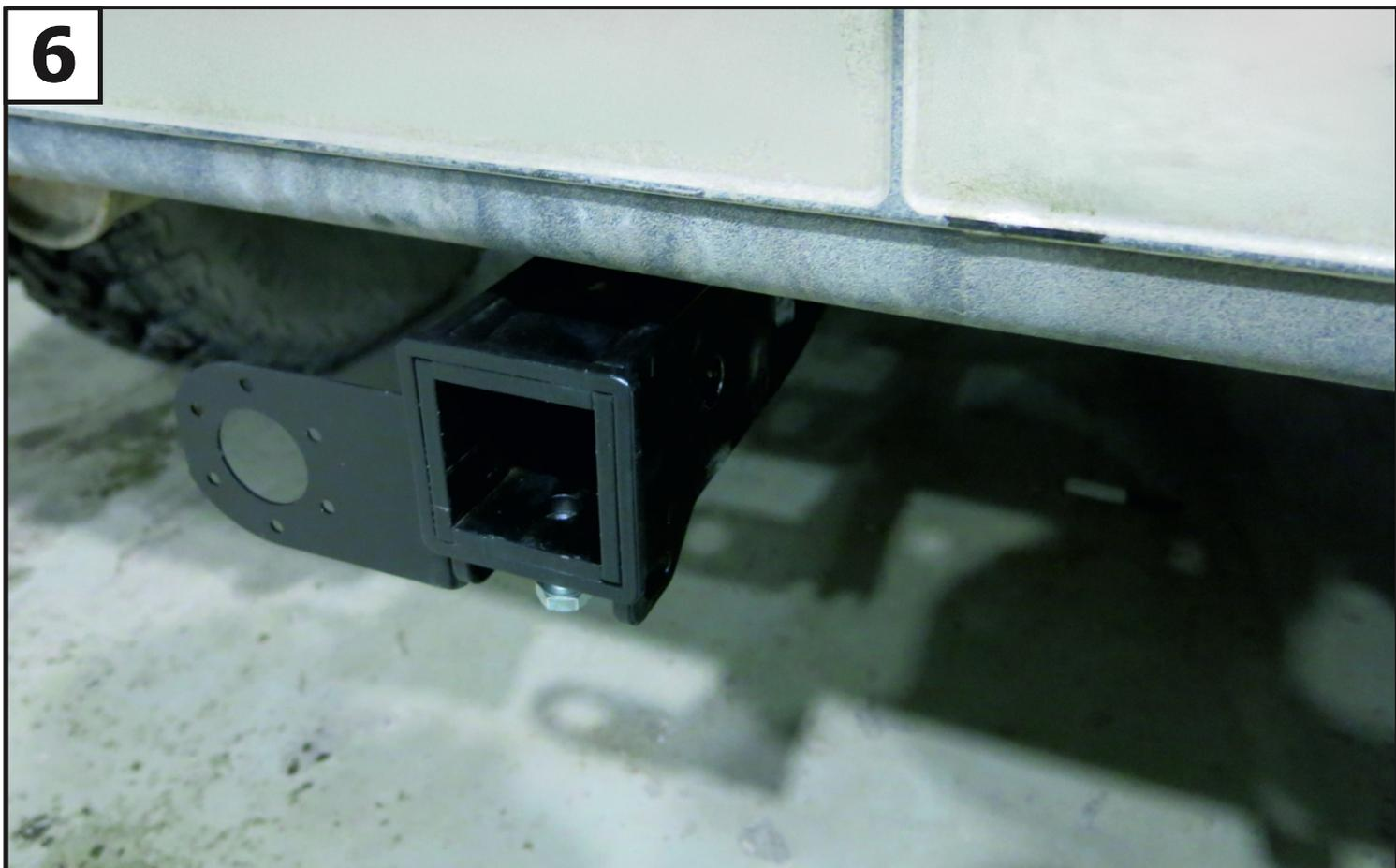
Установить кронштейн под розетку (7) на ТСУ (1) с помощью болта М8х25 (8), шайбы 8 (13), шайбы 8 пружинной (14), шайбы 8 увел. (15) и гайки М8 (11).
