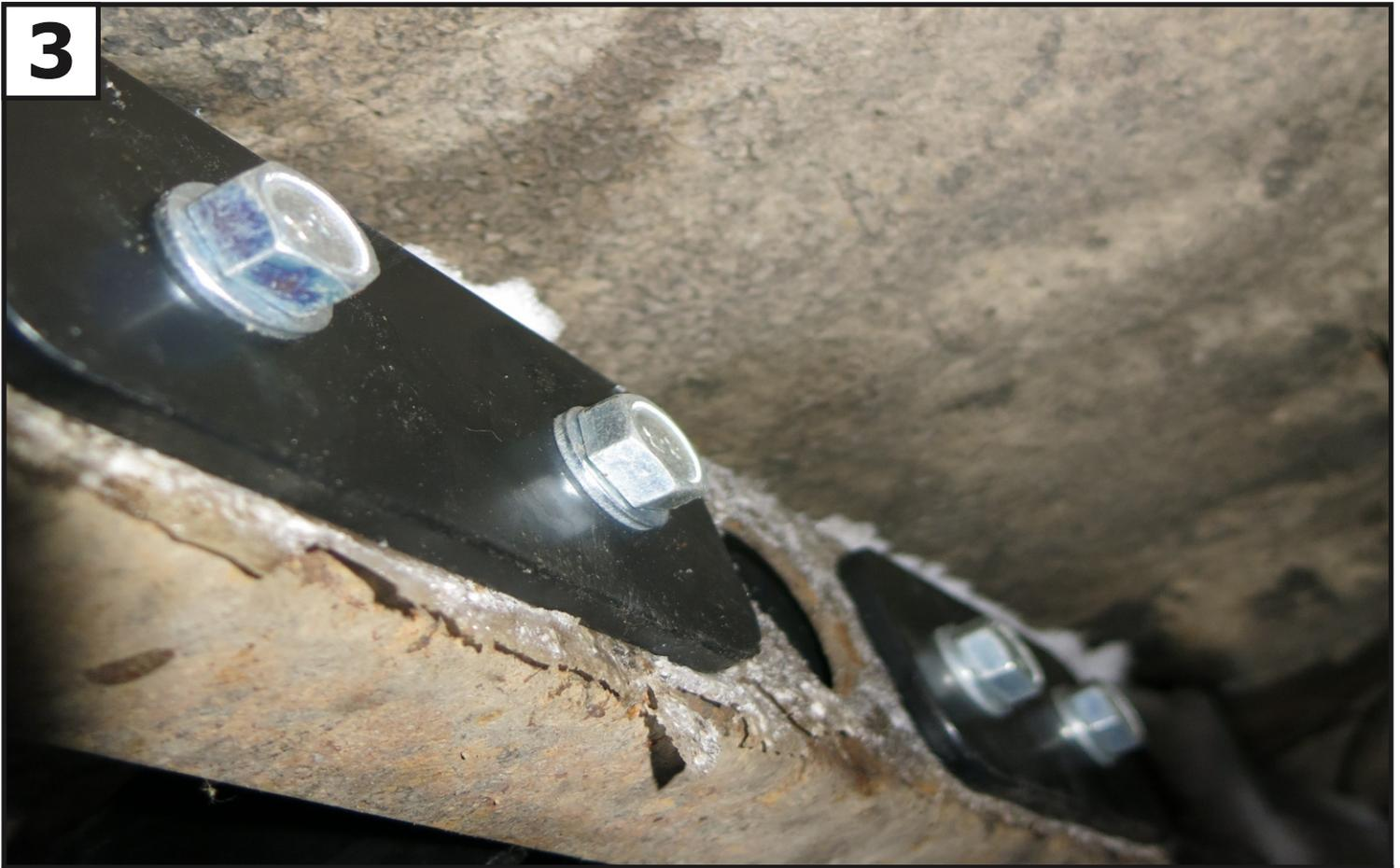
Затем закрепить ТСУ (1) к перекладине рамы автомобиля при помощи прижимных пластин (2), болтов М12х1,25х40 (10), шайб 12 (16), шайб 12 пружинных (17) и гаек М12х1,25 (12).
