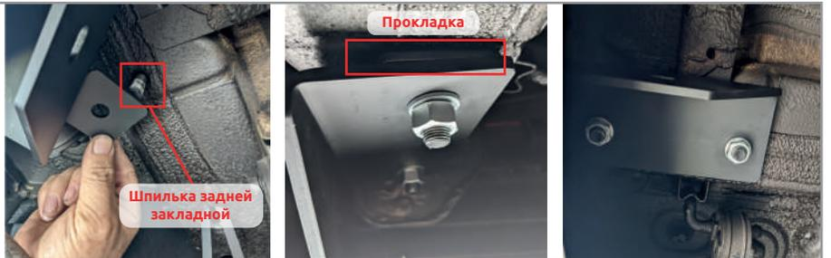
ШАГ 4. Установите балку ТСУ, соединив её с боковыми кронштейнами с помощью болтов M10x1,25x40, шайб 10, шайб 10 гроверных и гаек M10x1,25. Не затягивайте соединения.
