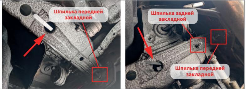
ШАГ 3. Будучи с левой стороны автомобиля, наживите на шпильку задней закладной металлическую прокладку, после чего зафиксируйте положение прокладки левого кронштейна, наживив его на шпильки закладных с помощью шайб 12, шайб 12 гроверных и гаек M12x1,25. Прделайте те же самые действия с правой стороны автомобиля.
