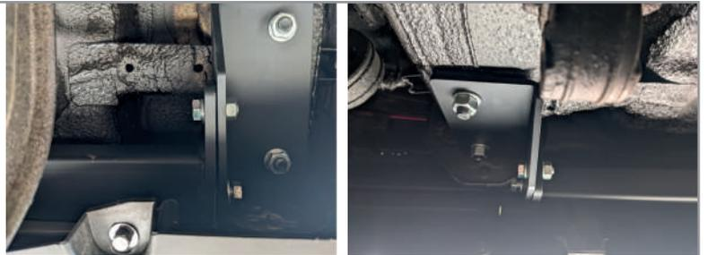
ШАГ 5. Установите кронштейн розетки при помощи шайбы 10, шайбы 10 гроверной и гайки M10. Установите съёмный шар в сборе и закрепите его пальцем гнутым гальванизированным со шплинтом пружинным игольчатым. Затяните шар ключом на 38 мм. Установите фиксирующий болт M10x20 снизу, он используется для исключения технологических люфтов съёмного шара и только в ненагруженном состоянии! Перед сцепкой болт демонтировать!
