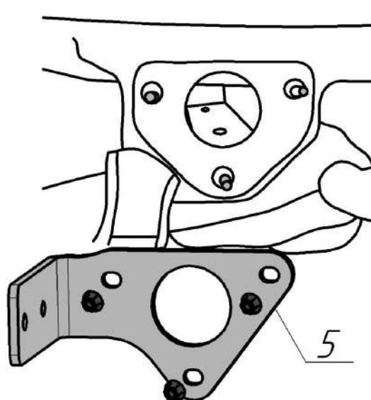
**6** Закрепите балку к кронштейнам (2,3,4,5) с помощью крепежных изделий (14,17,18) и (14,18,20) с двух сторон.
