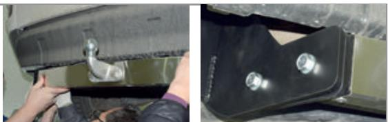
**ШАГ 6.** Отрегулируйте положение фаркопа, обеспечив небольшой зазор между центральным кронштейном и бампером автомобиля. Установите кронштейн розетки, закрепив болтом M10x20, шайбой 10 и шайбой 10 гроверной.
