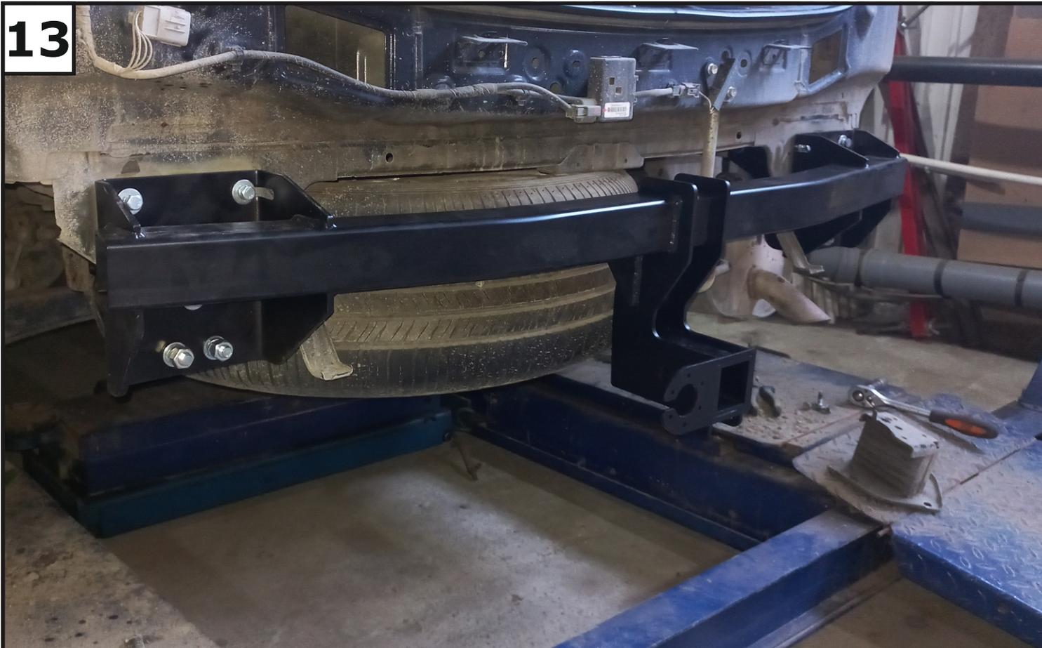
К установленным кронштейнам (2) закрепить балку (1) с помощью болтов М12х1,25х40 (9), шайб 12 пружинных (16), шайб 12 (15) и гаек М12х1.25 (12). Так же прикрепить балку к кузову автомобиля с помощью болтов М8х25 (7), шайб 8 увел. (13) и шайб 8 пружинных (14).
