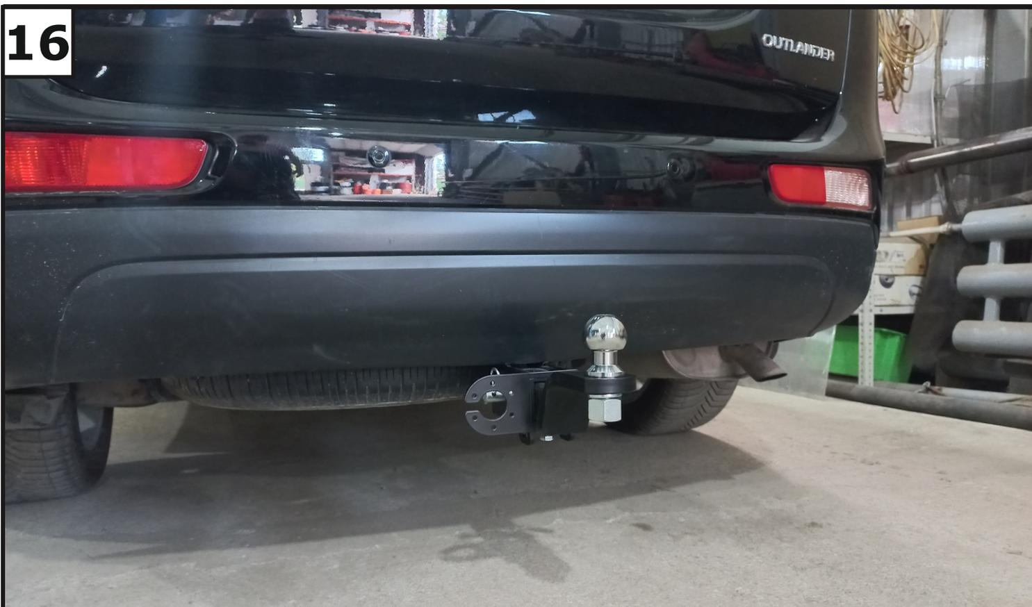
**Установить переходник (3), закрепив с помощью штифта (5) и шплинта (6). Зафиксировать переходник болтом M10x20 (8) - фиксацию использовать только без нагрузки. Установить на переходник шар (4), закрепив гайкой M24 (17) с шайбой 24 пружинной (18). Момент затяжки M24=95 Нм.**
