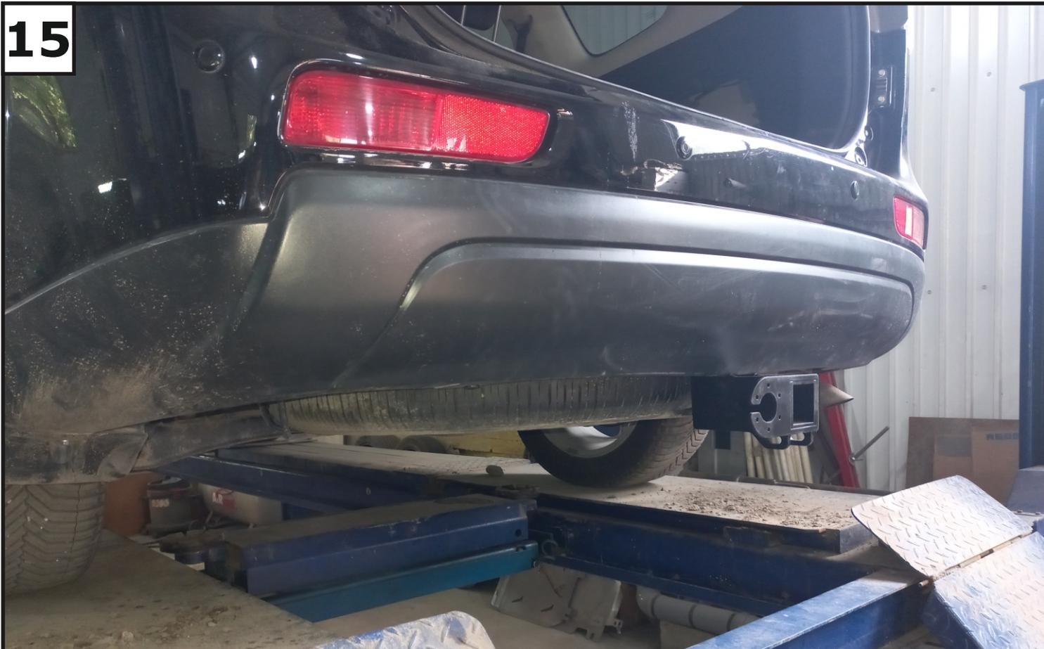
**Затянуть все резьбовые соединения. Моменты затяжки: M8=25 Нм, M12=81 Нм.
