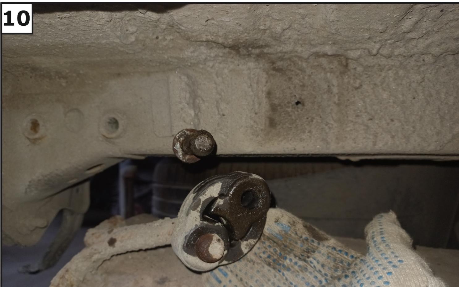
Для удобства установки кронштейна (2) необходимо снять крепление глушителя.
