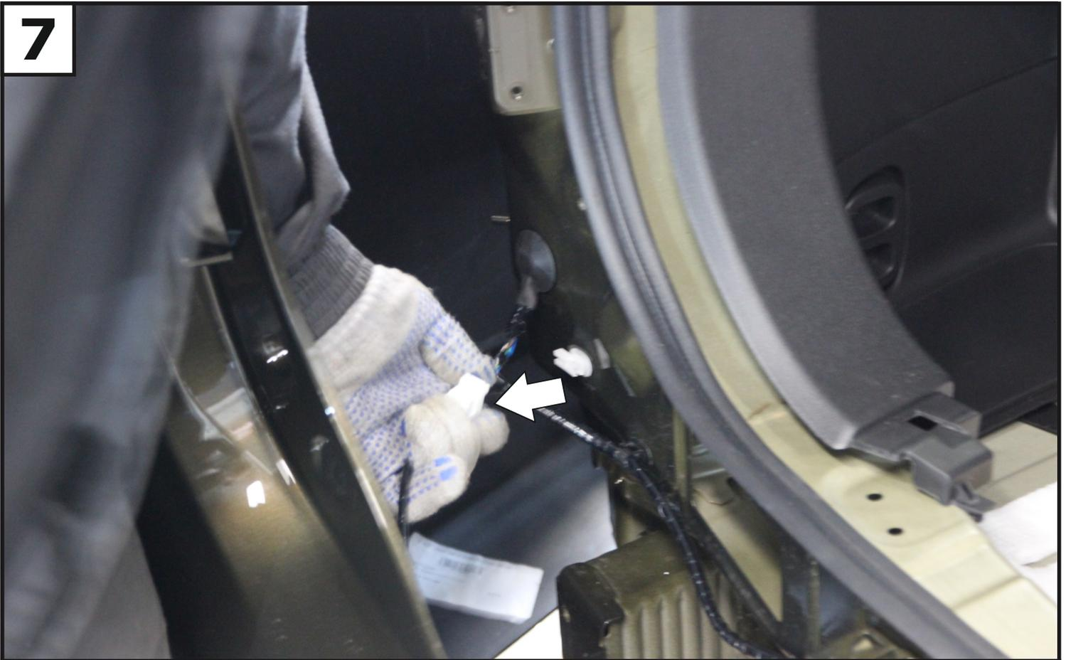
Перед съемом бампера необходимо отключить фишку датчиков парковки и заднего ПТФ. После снять бампер с автомобиля.
