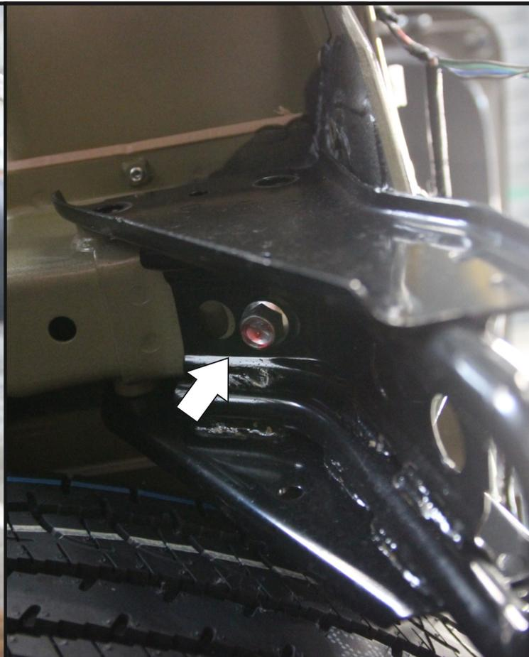
Демонтировать буксировочную петлю с автомобиля открутив штатные болты. Для дальнейшей установки ТСУ буксировочная петля не требуется.
