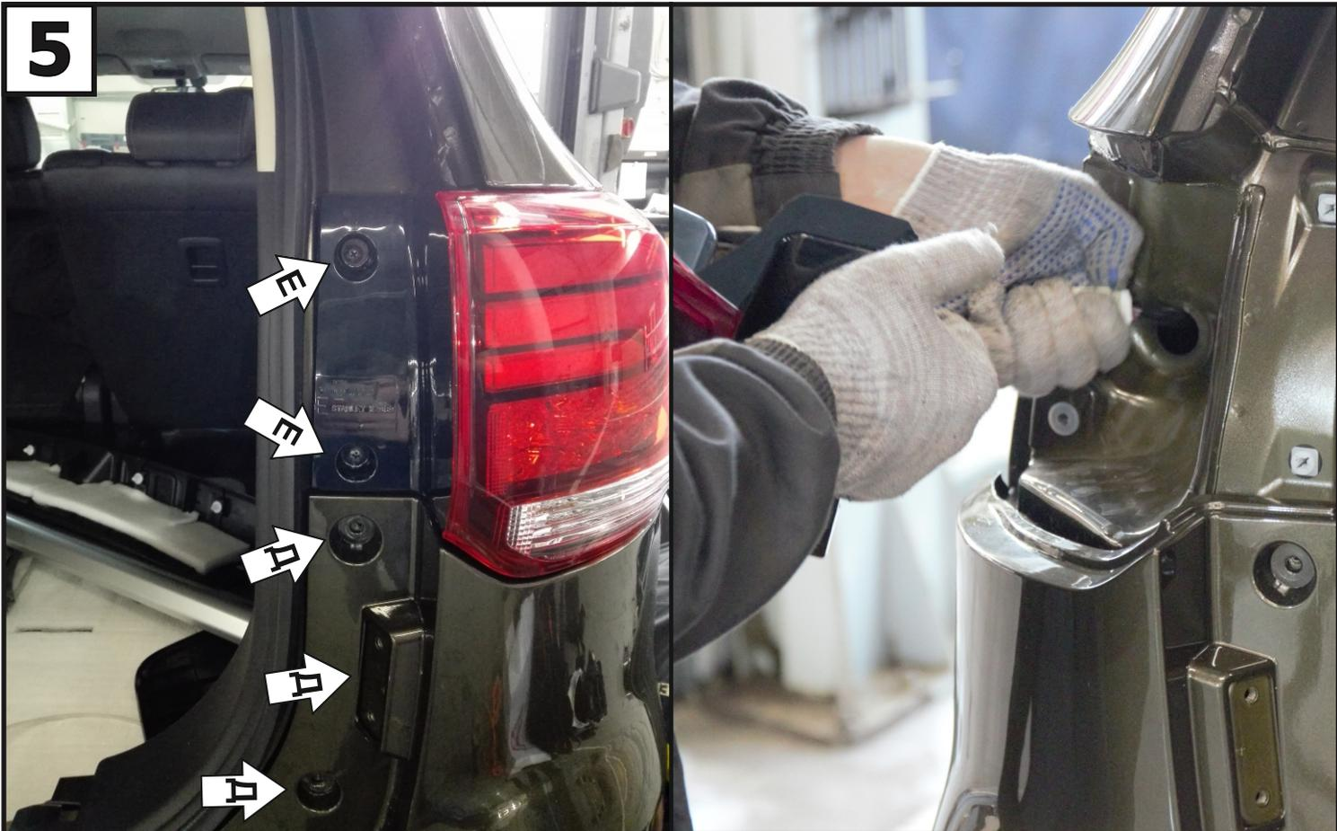
Открутить винты крепления бампера Д и винты крепления заднего фонаря Е. После демонтировать задний фонарь. С другой стороны аналогично.
