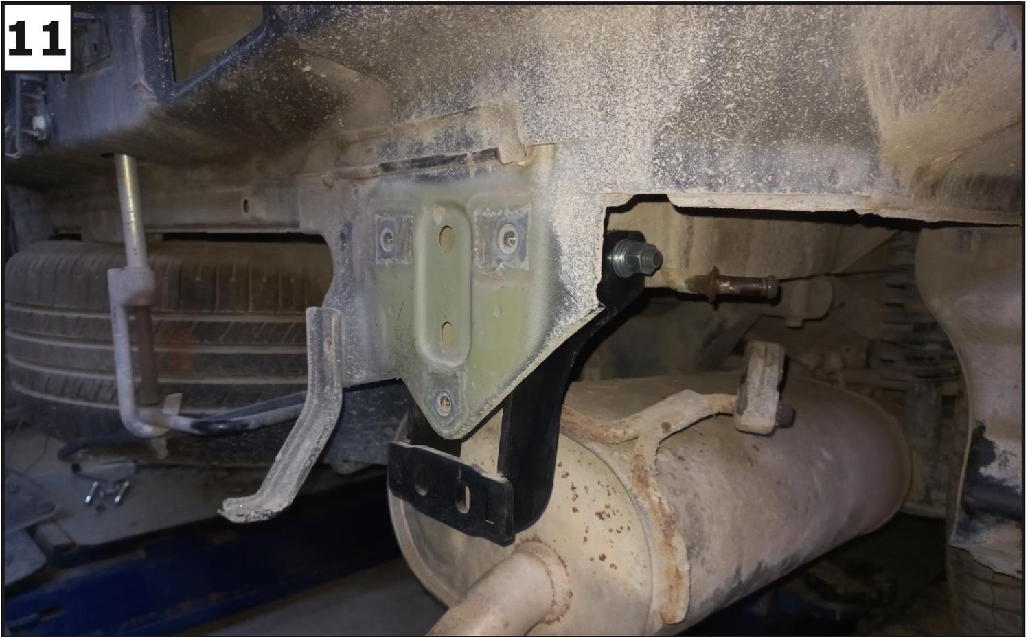
**Закрепить кронштейн (2) в лонжероне автомобиля с помощью болтов М12х120 (10), шайб 12 (15), шайб 12 пружинных (16) и гаек М12 (11). С другой стороны аналогично.**
