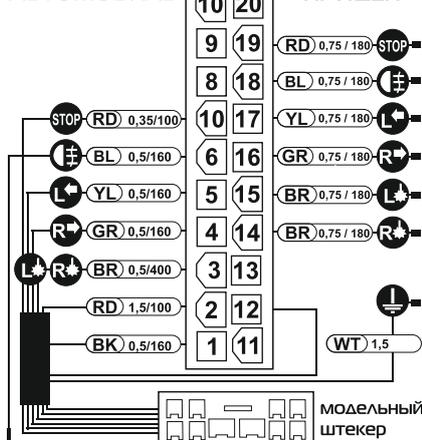
Для вывода сигнала заднего хода на фонарь прицепа, необходимо установить синий провод с наконечником в модельную колодку шлейфа проводов (на рис.) в гнездо №3 (со стороны установленных в колодку проводов, счёт гнезд слева на право, сверху вниз). Для вывода сигнала ПТФ на фонарь прицепа, необходимо выполнить его соединение с соответствующим проводом жгута проводов автомобиля (в нижней левой части багажника) — провод необходимо найти в жгуте с помощью контрольно-измерительного устройства.
