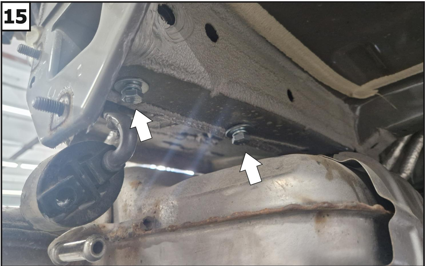
Установленные закладные (4) и (5) закрепить с помощью болтов M8x30 (8), шайб 8 пружинных (13), шайб 8 увел. (14) и болтов M10x1,25x30 (9), шайб 10 пружинных (15) и шайб 10 увел. (16). С другой стороны аналогично.
