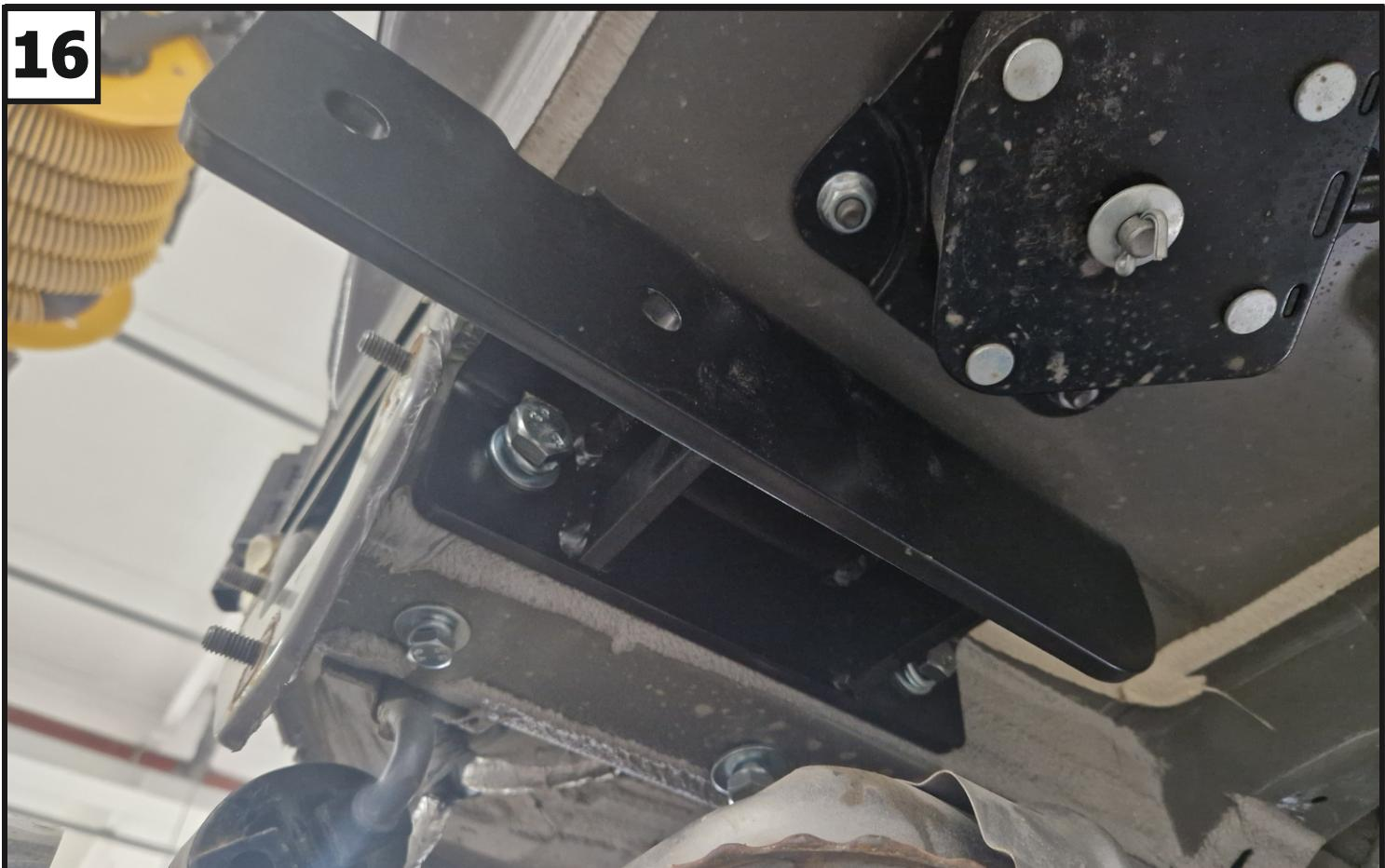
Установить кронштейны (2) и (3) согласно их стороне, закрепив их с помощью болтов M12x1,25x40 (10), шайб 12 пружинных (17) и шайб 12 (18).
