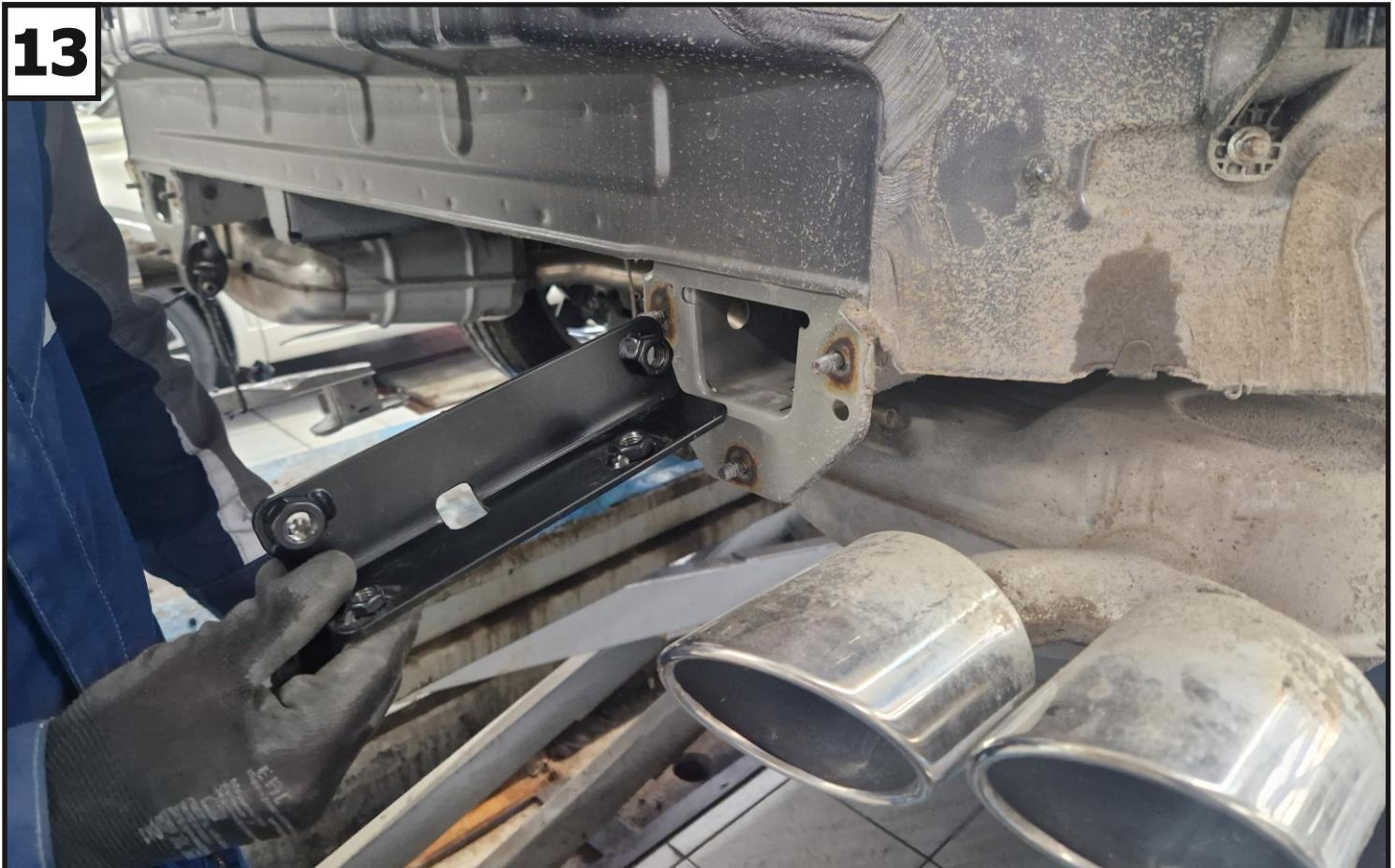
Установить в лонжероны автомобиля закладные (4) и (5), согласно их стороне. При наличии в лонжеронах штатных гаек - закладные не используются.
