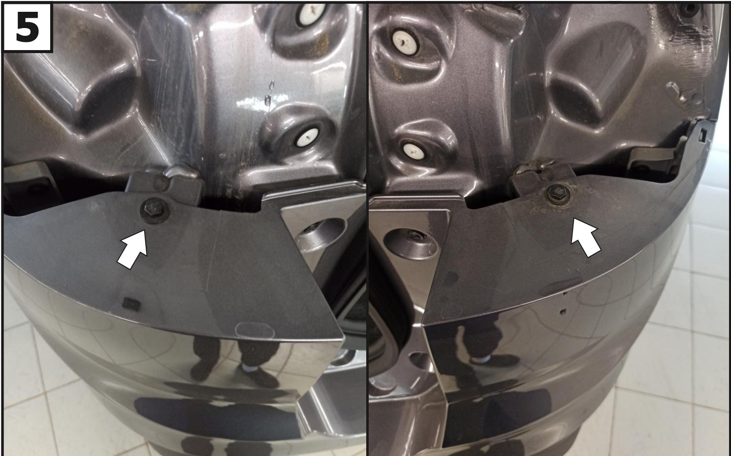
После снятия задних фонарей открутить болты крепления бампера с левой и правой стороны автомобиля.
