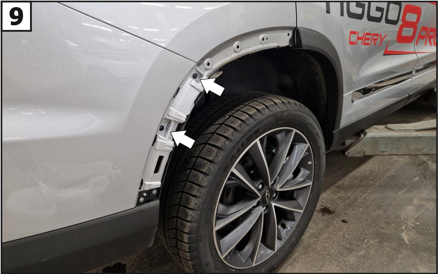
После демонтажа боковой накладки выкрутить винты крепления бампера. С другой стороны аналогично.
