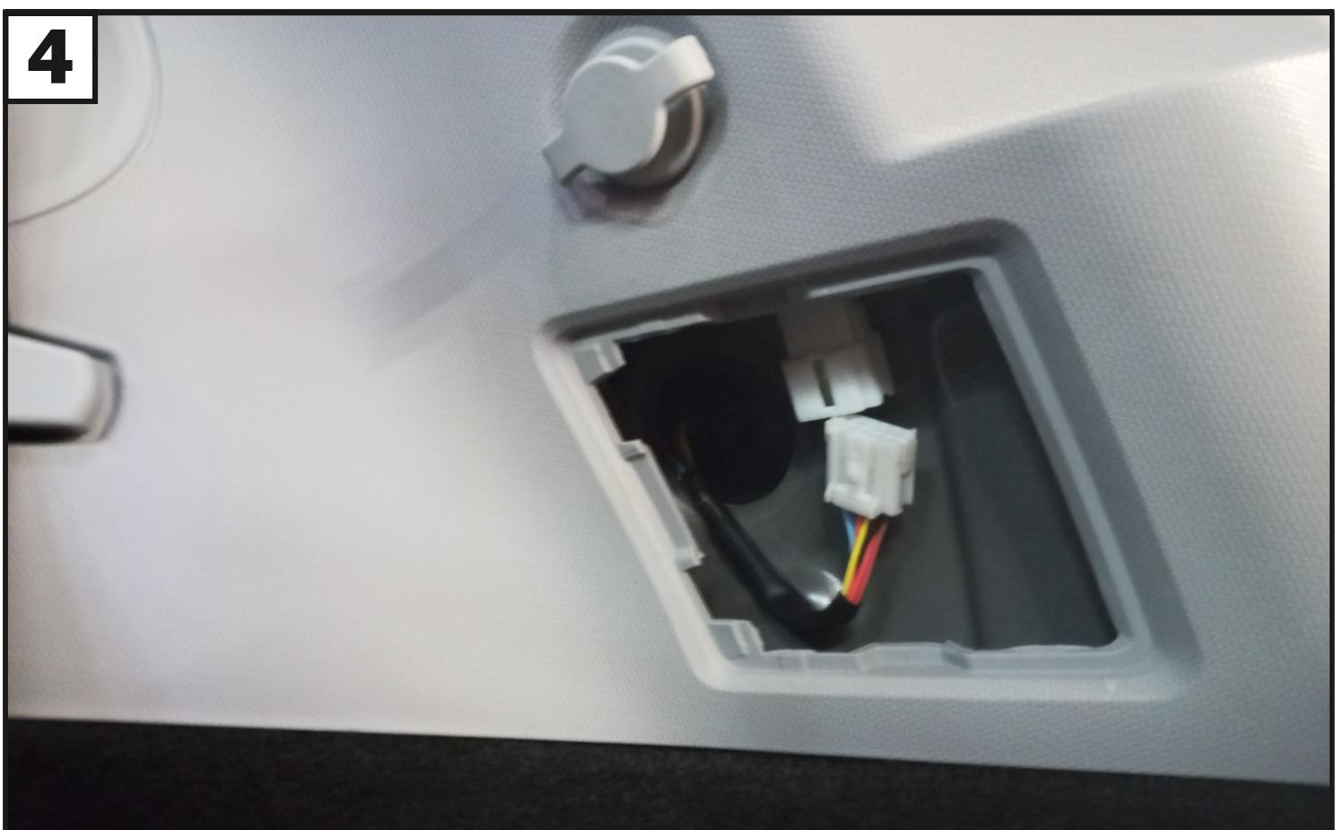
**В багажнике снять заглушки обшивки и отсоединить фишку заднего фонаря. Далее демонтировать фонарь. С другой стороны аналогично.**
