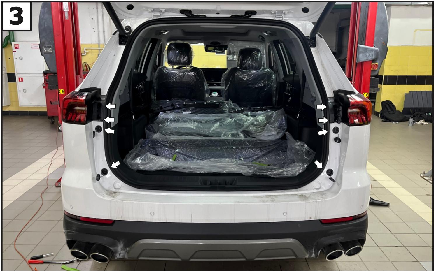
**Открыть заглушки фонарей и выкрутить винты заднего левого и правого фонаря, после выкрутить винты крепления бампера.**
