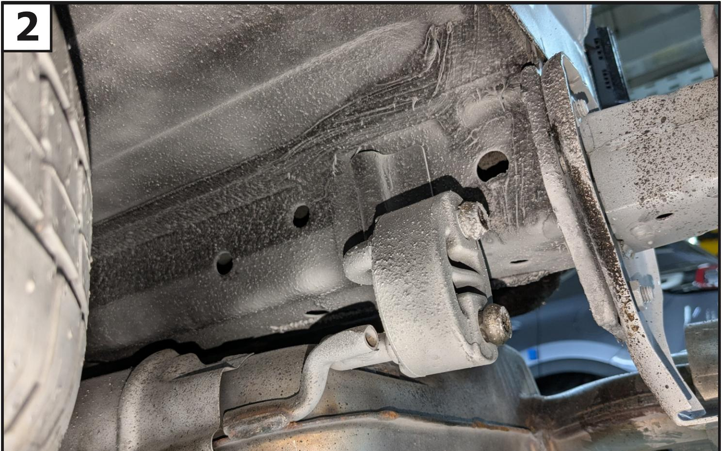
**При отсутствии штатных резьбовых гаек в лонжеронах, требуется снятие бампера и установка закладных (4) и (5) согласно инструкции по установке.**
