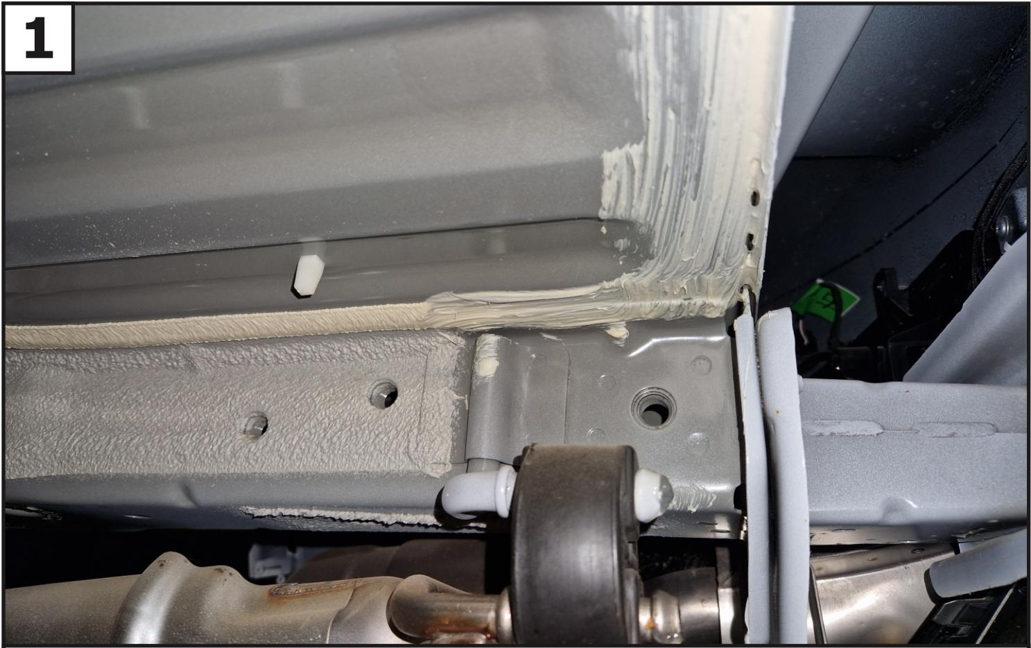
**При наличии штатных резьбовых гаек в лонжеронах, снятие бампера и установка закладных (4) и (5) не требуется. Установку ТСУ начинать с пункта №16 согласно инструкции.**
