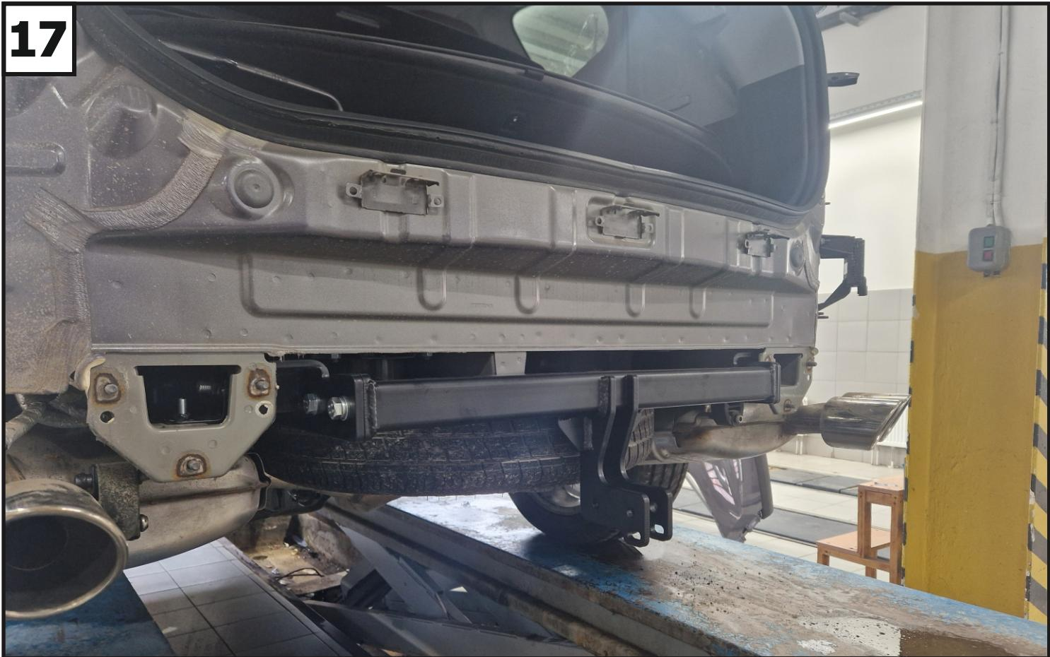
Прогнать резьбовые отверстия балки (1) с помощью метчика M12x1,25. Установить балку (1), закрепив её к кронштейнам с помощью болтов M12x1,25x40 (10), шайб 12 пружинных (17), шайб 12 (18) и гаек M12x1,25 (12).
