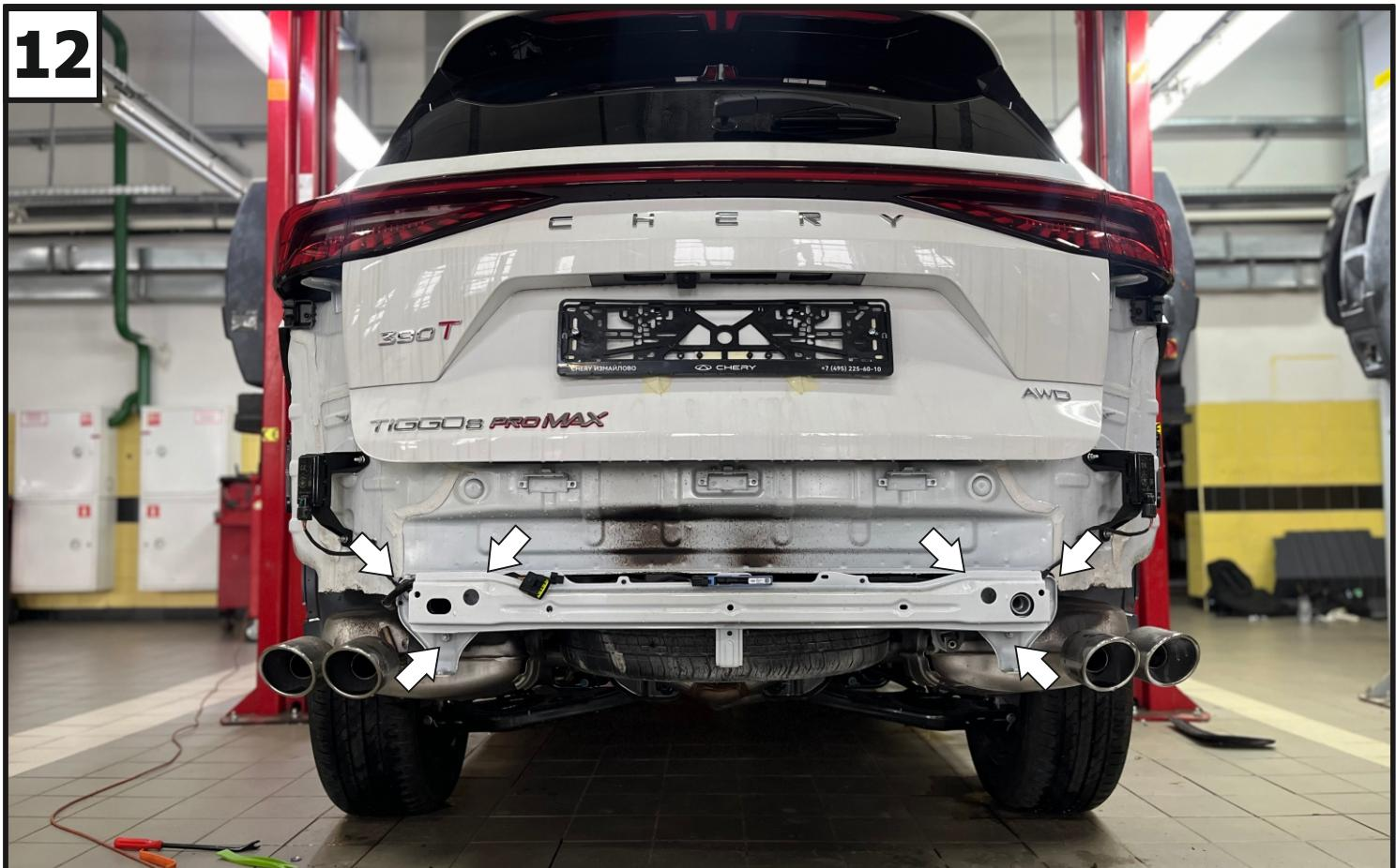
Отсоединить фишки боковых радаров, отсоединить точки крепления проводки и антенну бесключевого доступа от заднего усилителя. Открутить гайки крепления усилителя и демонтировать его.
