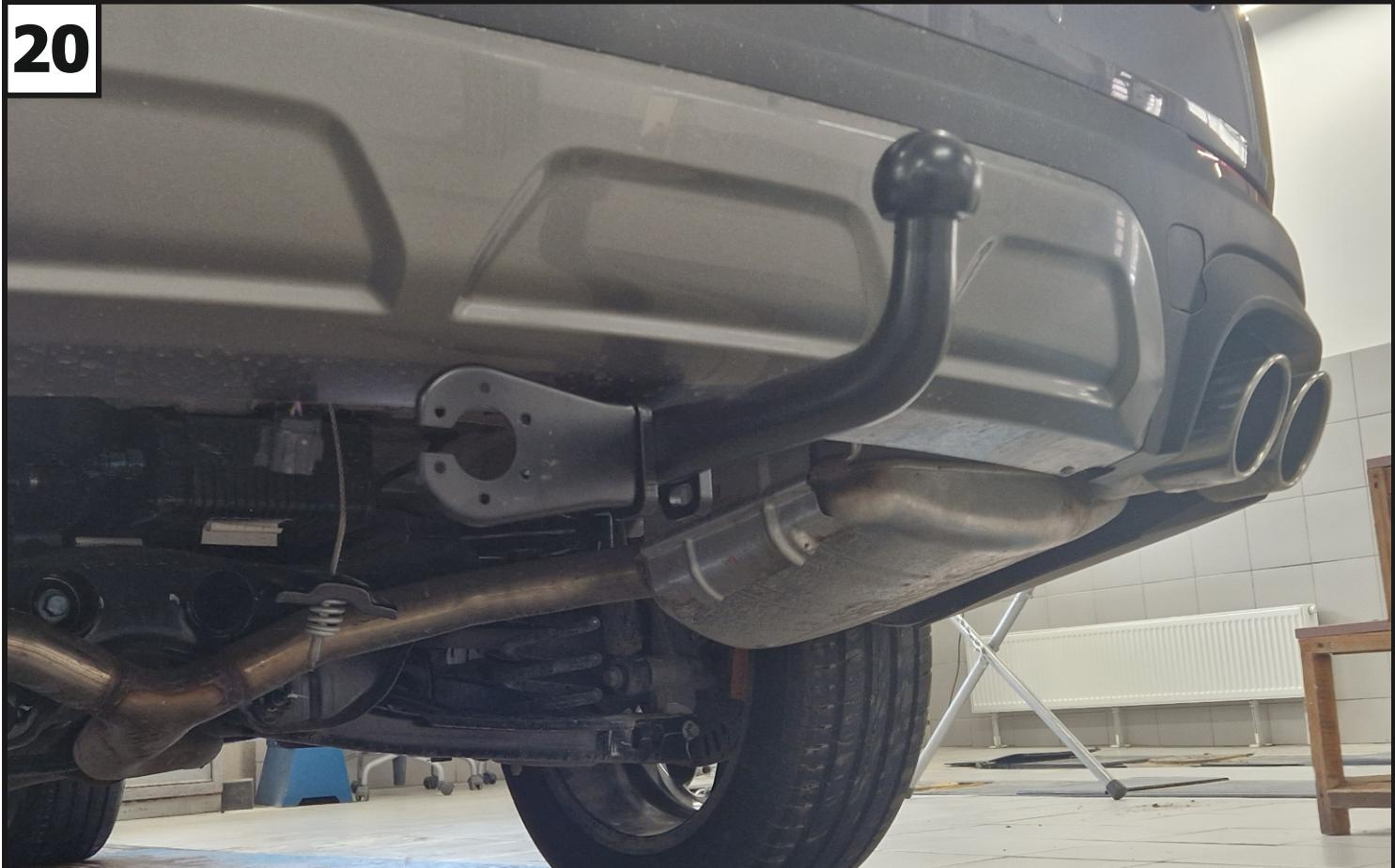
Установить кронштейн под розетку (6) и крюк (7) с помощью болтов M12x1.25x70 (11), шайб 12 пружинных (17), шайб 12 (18) и гаек M12x1.25 (12). Затянуть резьбовые соединения. Момент затяжки: M12=81 Нм.
