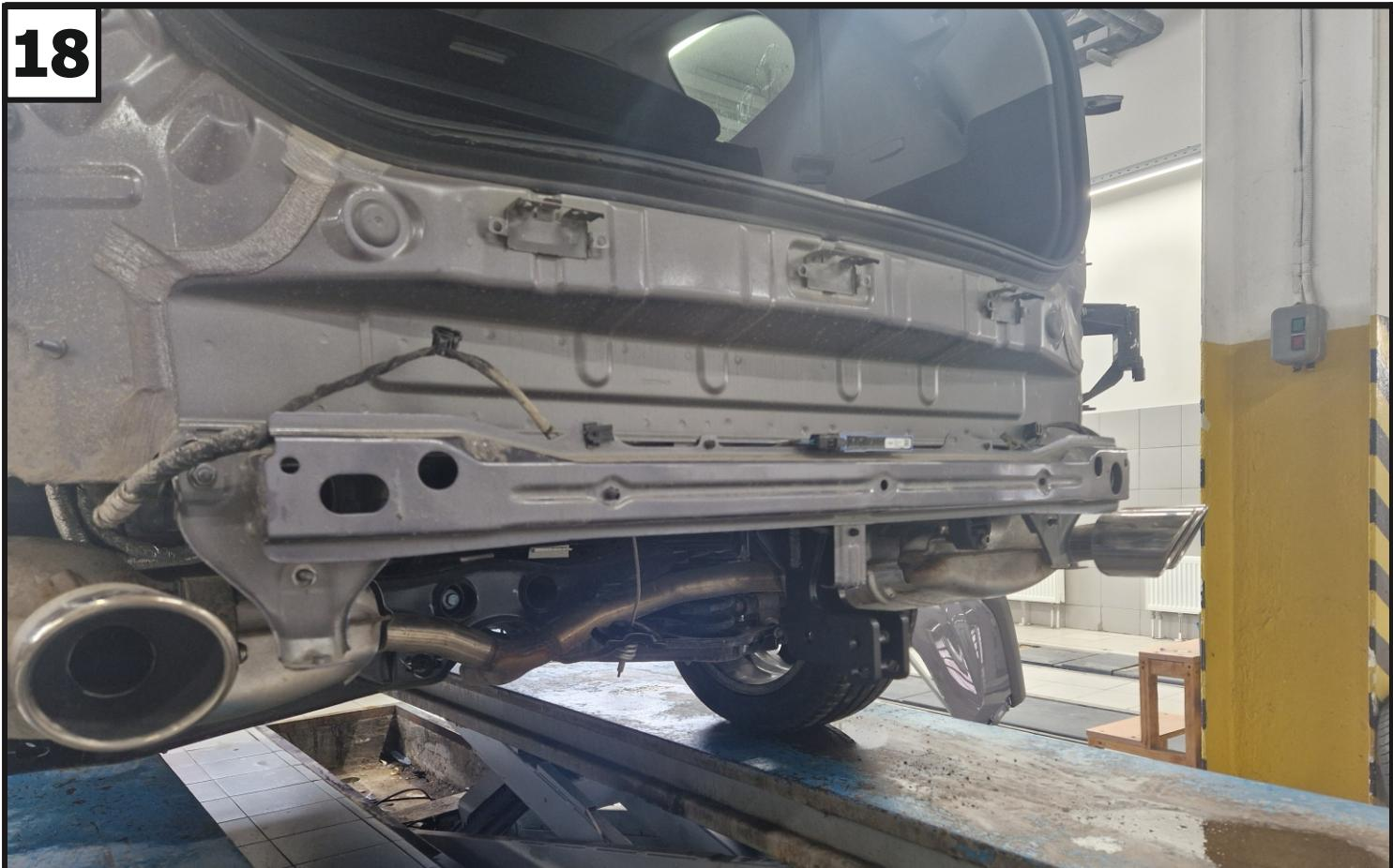
Затянуть все резьбовые соединения, сначала затянуть балку с кронштейнами, затем кронштейны с лонжеронами и закладными. Моменты затяжки: M8=25 Нм, M10=47 Нм, M12=81 Нм. Установить подвесы глушителя и усилитель в обратной последовательности.
