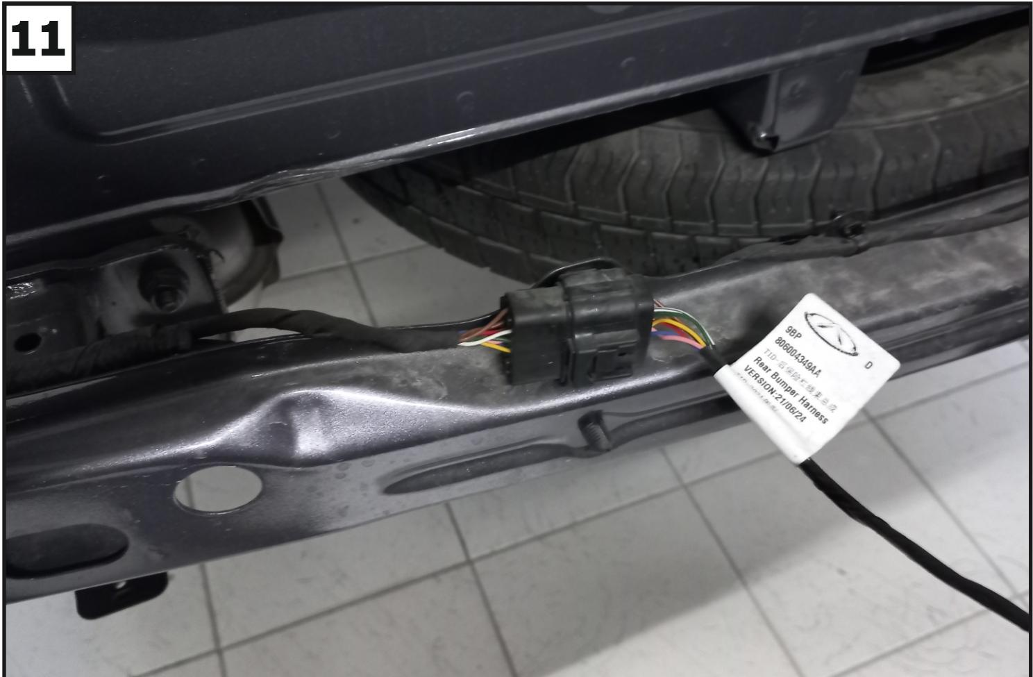
Перед полным снятием заднего бампера необходимо отсоединить разъем электропроводки.
