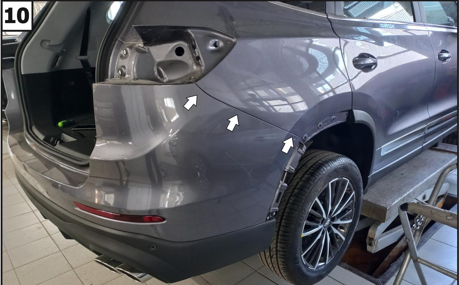
Отщелкнуть боковые защелки бампера с левой и правой стороны. Затем снять задний бампер с автомобиля.
