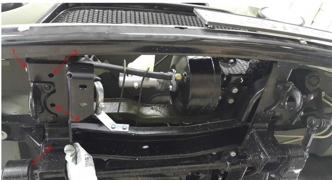
4. Разметить отверстия №3 и №4. Просверлить отверстия и закрепить кронштейны с двух сторон при помощи болтов М 10х30.
