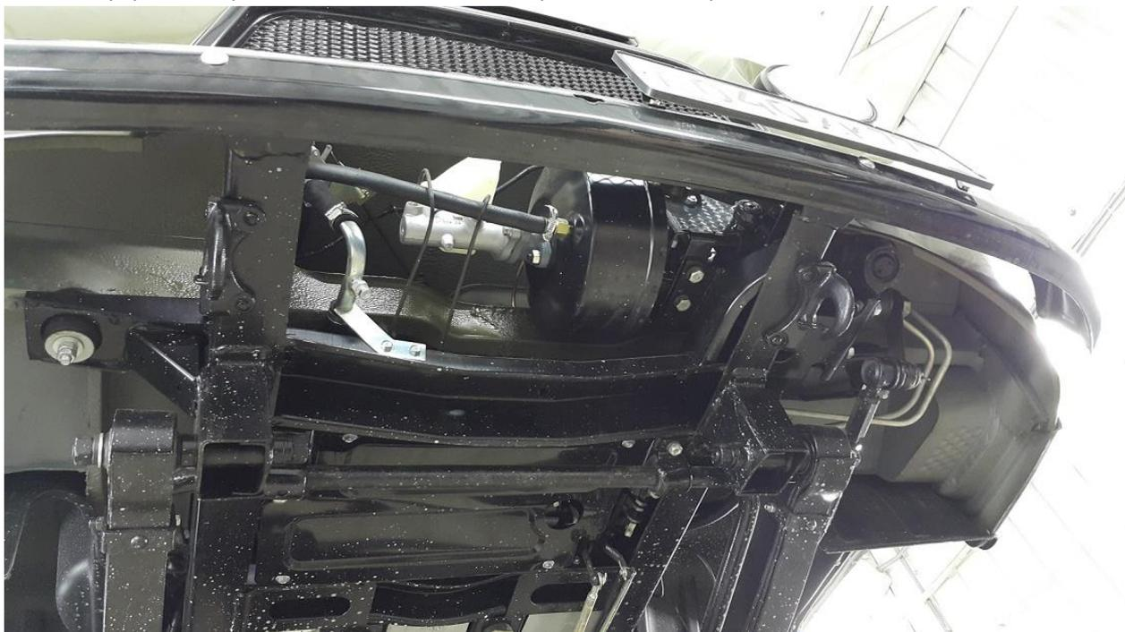
2. Для установки потребуется просверлить в передней части рамы 2 или 3 отверстия диаметром 10 мм с каждой стороны в зависимости от конструкции передней части рамы.
