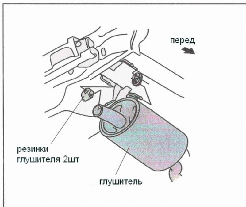
6. Устанавливаем резинки глушителя на правую лапу.
