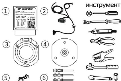
⚠ На некоторых авто белый провод "масса" устанавливаем в модельный разъём - определяем пин, используя тестер (зависит от модели авто), либо обжав на проводе массовое кольцо, размещаем на кузове автомобиля (предпочтительнее)
