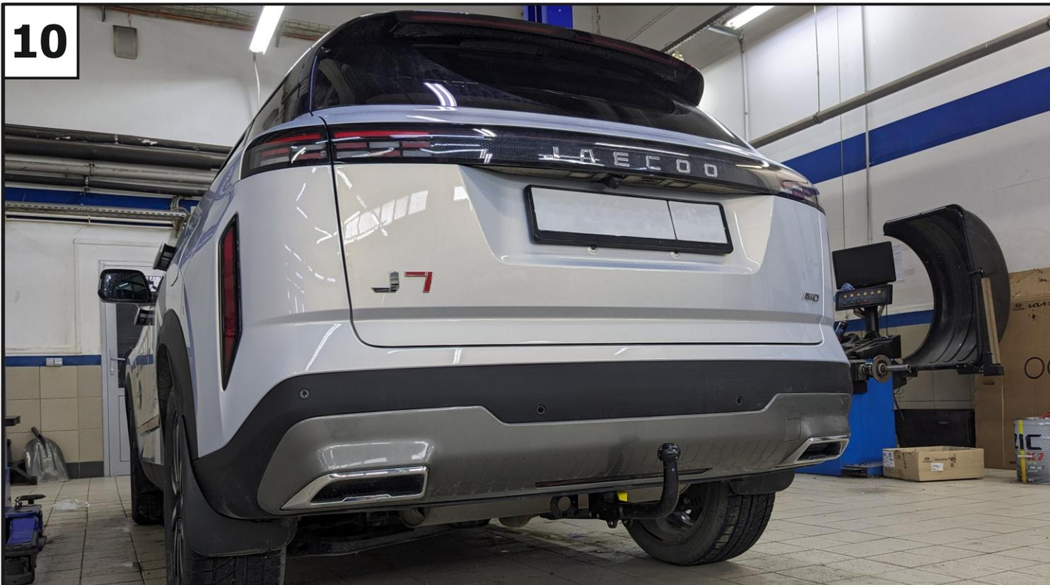
Установить вставку быстросъёма в ответную часть. Закрепить крюк (10) с помощью винтов М12х45 (16). Затянуть резьбовые соединения. Моменты затяжки: М6=10 Нм; М12=81 Нм.
