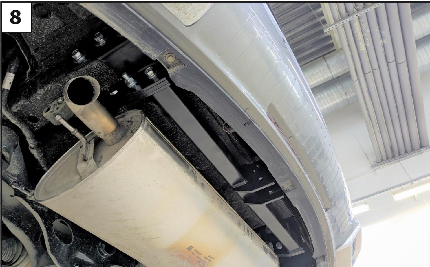
Затянуть все резьбовые соединения: сначала балку с кронштейнами, затем кронштейны с лонжеронами. Момент затяжки: М12=81 Нм. Установить глушитель на подвесы.
