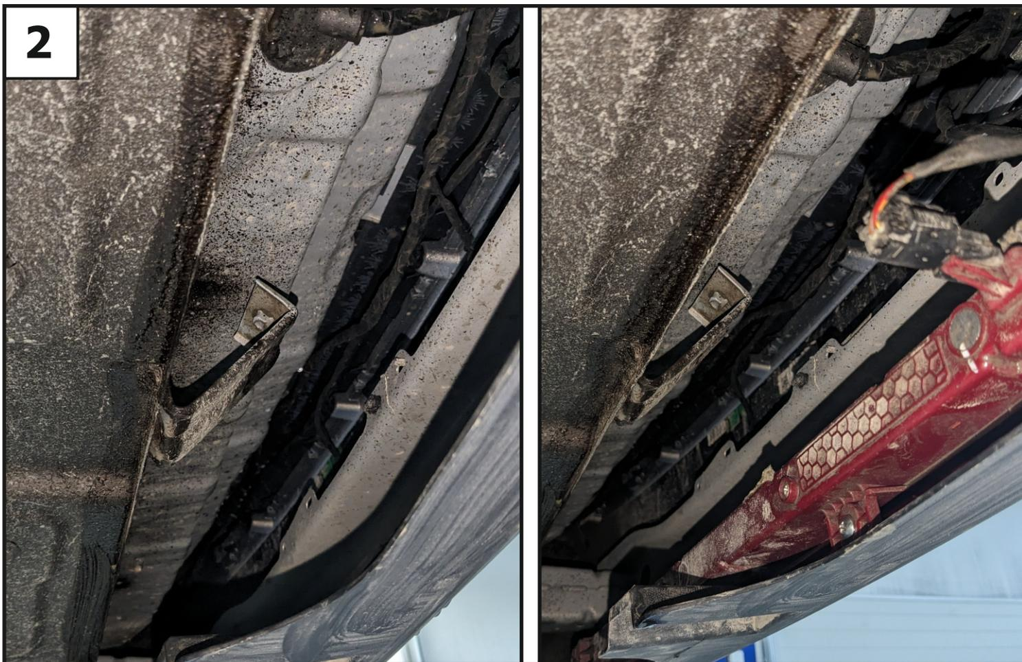
**Отогнуть штатный кронштейн крепления бампера. Установить противотуманный фонарь в обратном порядке.**
