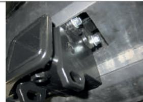
**ШАГ 5.** Установите съёмный шар в сборе и закрепите его пальцем гнутым гальванизированным со шплинтом пружинным игольчатым. Затяните шар ключом на 38 мм. Установите фиксирующий болт М10х20 снизу, **он используется для исключения технологических люфтов съёмного шара и только в ненагруженном состоянии! Перед сцепкой болт демонтировать!**
