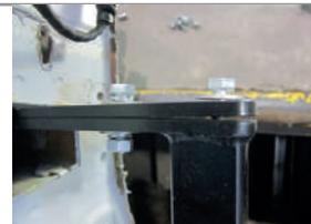
**ШАГ 3.** Закрепите каждую закладную пластину в ближнем отверстии с помощью болта М10х1,25х40 через шайбу 10 гроверную и шайбу 10. Затяните все резьбовые соединения. **Перед установкой бампера** наклейте на нижнюю юбку бампера шаблон по центру бампера и аккуратно вырежьте по контуру шаблона отверстие в бампере.
