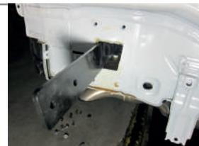
**ШАГ 2.** Закрепите каждую закладную пластину с помощью болта М10х1,25х40 и шайб 10 в дальнем отверстии закладной пластины. Установите балку ТСУ, совместив его отверстия с отверстиями в закладных пластинах и соедините их с помощью болтов М10х1,25х40, через шайбы 10 гроверные и шайбы 10, гайками М10х1,25.
