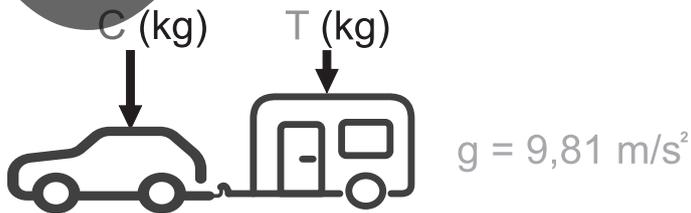
$$D \geq \frac{T \cdot C}{T + C} \cdot \frac{g}{1000} \text{ (kN)}$$
