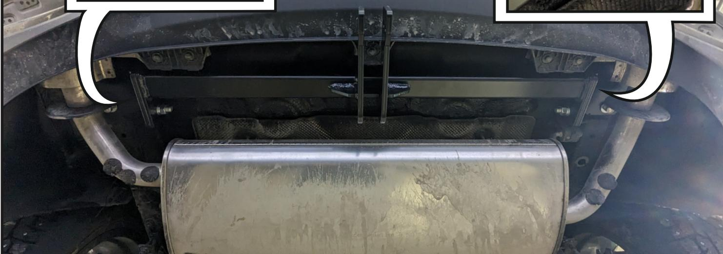
**Прогнать резьбовые отверстия балки (1) при помощи метчика М12х1,25. Затем установить балку (1), закрепив ее к кронштейнам с помощью болтов М12х1,25х40 (8), шайб 12 пружинных (13) и шайб 12 (14).**
