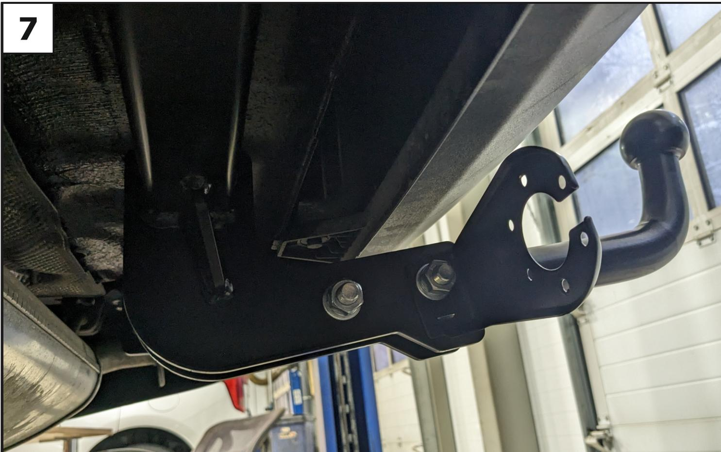
Установить кронштейн под розетку (5) и крюк (6) с помощью болтов М12х1,25х70 (9), шайб 12 (14), шайб 12 пружинных (13) и гаек М12х1,25 (10). Закрутить нижние болты крепления бампера.
