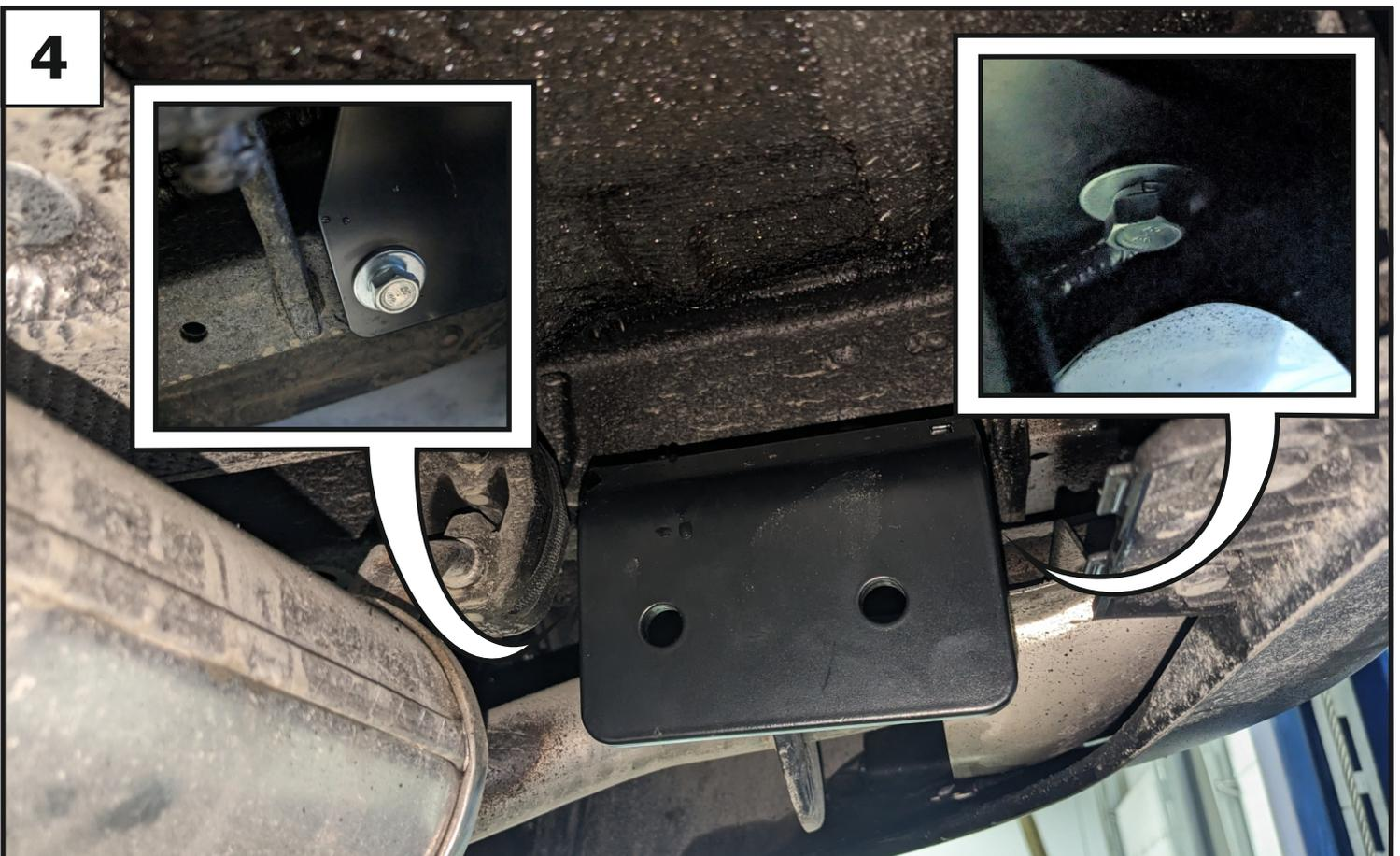
Установить кронштейн правый (3), закрепив его к установленным закладным с помощью болтов M10x1,25x40 (7), шайб 10 пружинных (11) и шайб 10 увел. (12). Кронштейн левый (2) установить аналогично.
