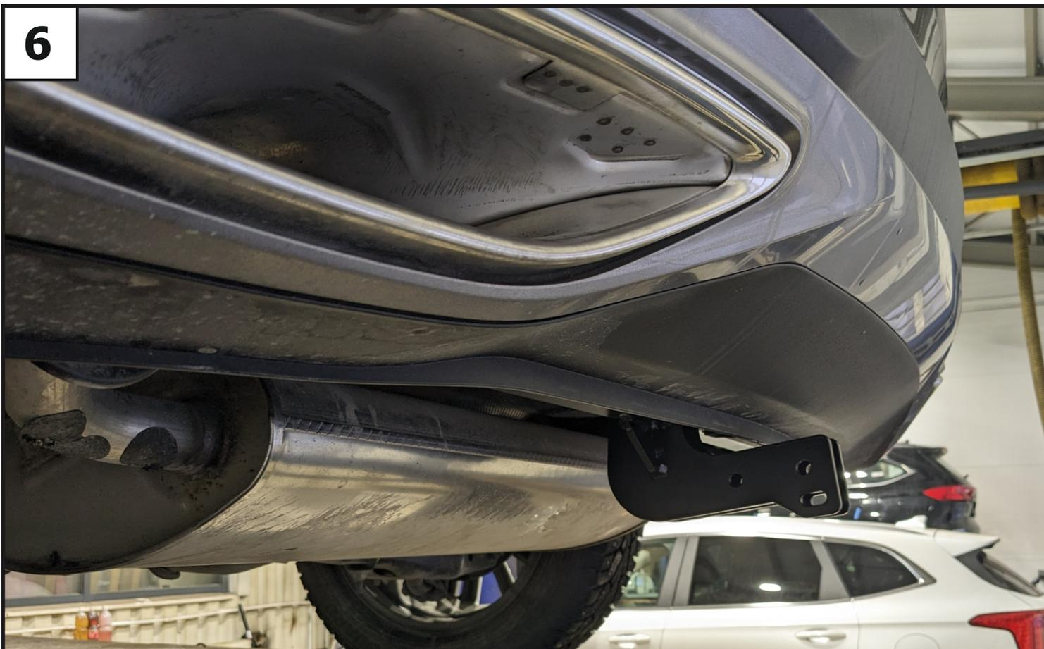
**Отрегулировать балку относительно центра автомобиля. Затянуть все резьбовые соединения: сначала балку с кронштейнами, затем кронштейны с лонжеронами. Моменты затяжки: М10=47 Нм; М12=81 Нм.**
