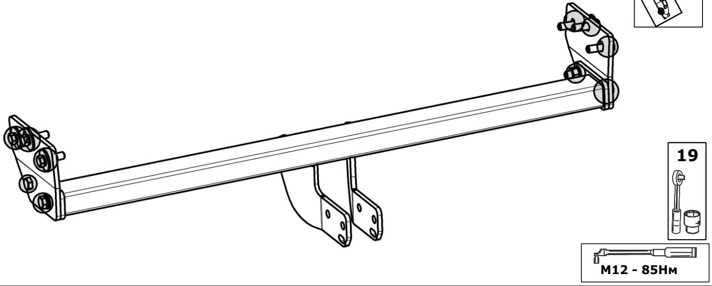
**4** Установите шар (4) и кронштейн розетки (5), с помощью крепежных изделий, как указано на схеме.
