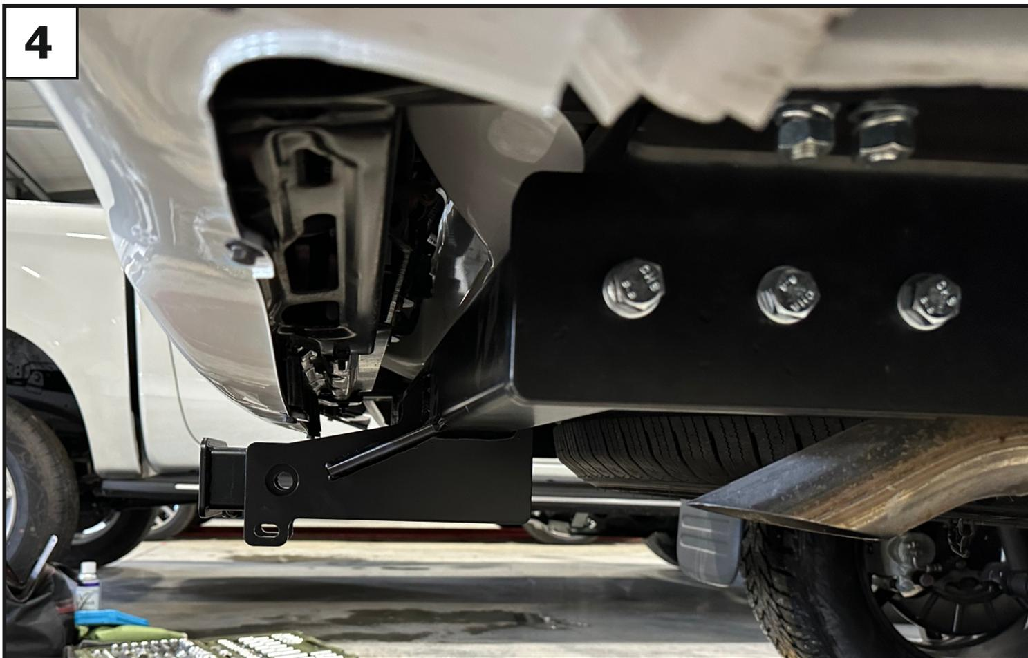
**Установить балку (1), закрепив ее к кронштейнам с помощью болтов М12х1,25х45 (11), шайб 12 пружинных (13) и шайб 12 (14).**
