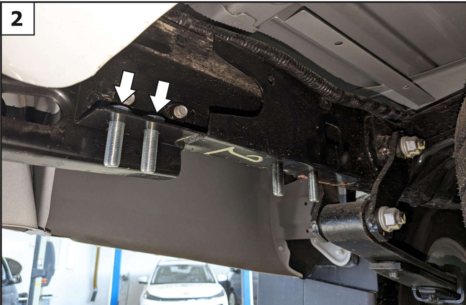
Установить болты М12х1,25х40 (10) и шайбы 12 (14) в лонжероны рамы.
