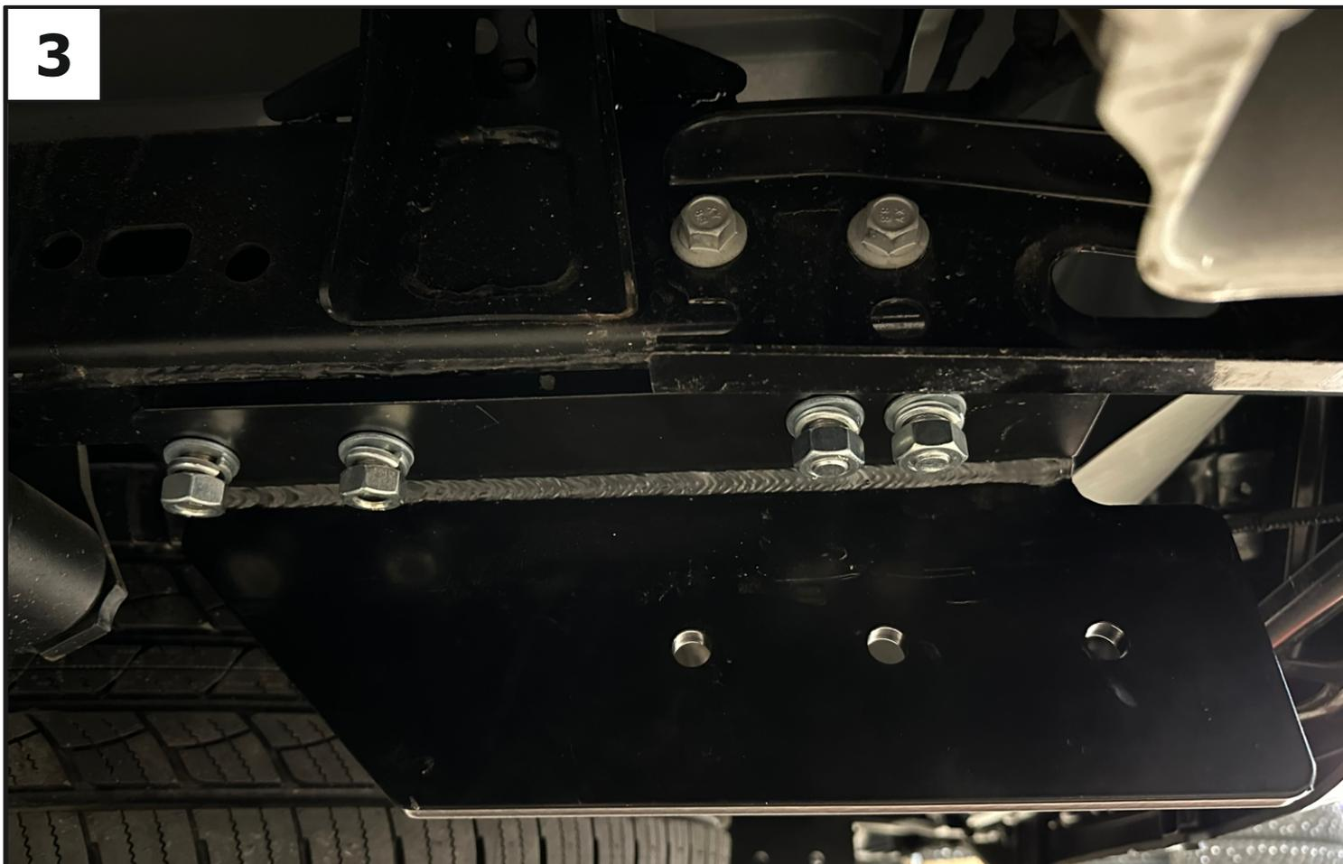
**Установить кронштейны (2 и 3), закрепив их к установленным закладным и болтам с помощью гаек М12х1,25 (12), шайб 12 пружинных (13) и шайб 12 (14).**
