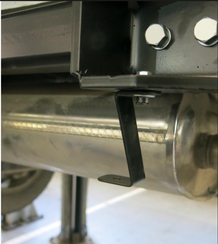
Установить левый (9) и правый (10) кронштейны бампера с помощью болтов M6х25 (13), шайб 6 (19), шайб 6 пружинных (21) и гаек M6 (17). Установить кронштейн антенны (11) по середине балки с помощью болта M6х90 (12), шайб 6 (19), шайбы 6 пружинная (21) и гайки M6 (17). После установить задний бампер в обратной последовательности.
