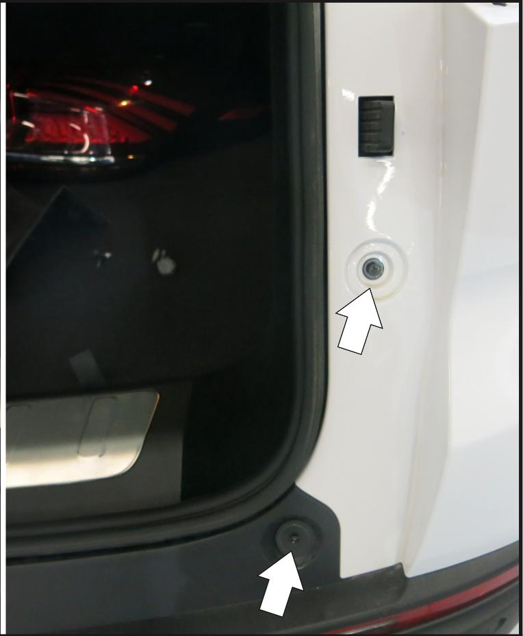
**Выкрутить винты крепления заднего бампера и демонтировать бампер.**
