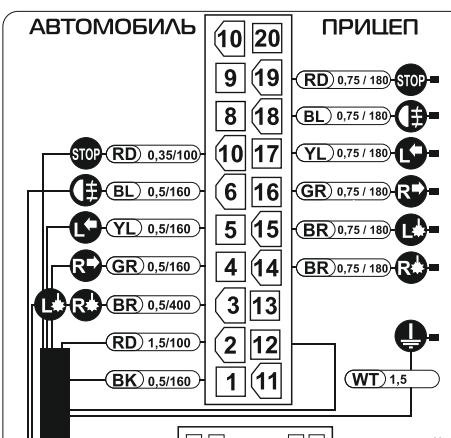
Для вывода сигнала заднего хода на фонарь прицепа, необходимо установить синий провод с наконечником в модельную колодку шлейфа проводов в гнездо №5 (со стороны установленных в колодке проводов, счет гнезд слева на право, сверху вниз). Для вывода сигнала ПТФ на фонарь прицепа, необходимо выполнить его соединение с соответствующим проводом жгута проводов автомобиля (в нижней левой части багажника) — провод необходимо найти в жгуте с помощью контрольно-измерительного устройства.
