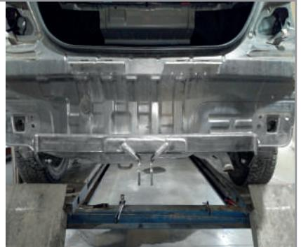
**ШАГ 4.** Зафиксируйте положение крюка и подразетника, соединив их отверстия с отверстиями на «ушах» балки и закрепив их болтами M12x1,25x80, шайбами 12, шайбами 12 гроверными и гайками M12x1,25.
