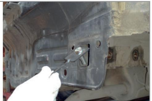
**ШАГ 2.** Совместите отверстия в лонжероне и шпильки закладных деталей с отверстиями боковых кронштейнов и зафиксируйте положение при помощи болтов M12x40x1,25, шайб 12, шайб гроверных 12 и гаек M12x1,25.
