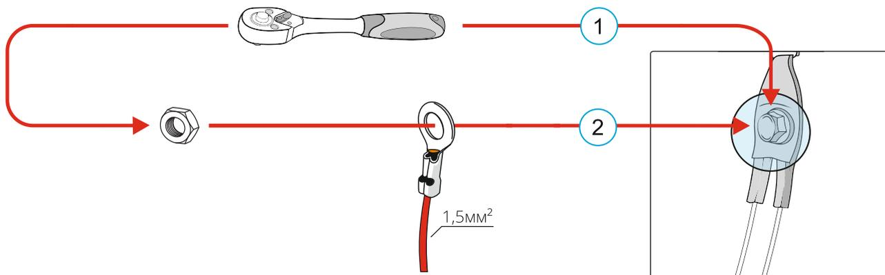
Подключение питания блока согласования осуществляется в багажном отсеке автомобиля с левой стороны к плюсовому силовому кабелю, как у казано на иллюстрациях выше.
